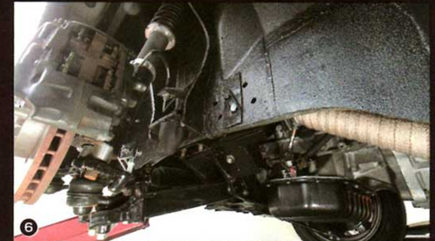
④エンジンはセルシオ用の1UZを換装。ECUまで合わせてのノーマル移植だが、それでも260ps、トルク36kgf-mの出力は十分な走行性能をもたらせる。⑤快適なストリート仕様を目指して製作されたため、オートエアコンも装備。構成パーツの寸法や制御の行いやすさから、エンジンがトヨタ車からの移植なのに対し、エアコンやパワステなどのドナーは日産車となっている。⑥エンジンの換装にあたっては、低く、後方へを実現させるべく配慮がされ、フロントメンバーが製作された。ステアリングもラック&ピニオン(パワステ付き)化されているという点も見逃せない。
