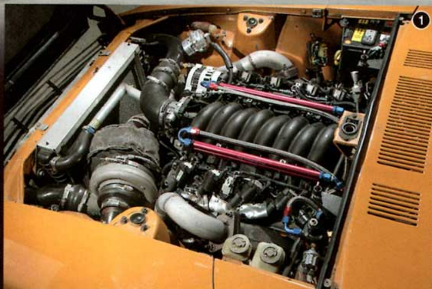
①②エンジンはコルベットなどに搭載されているLS1、大型のトラック用ターボによる過給で約700psを発揮するという。制御は、メガスカートというフルコン(と思われる)。詳細に関しては不明だが、作りはかなりマニアックなドラッグスペシャルとなっている。
