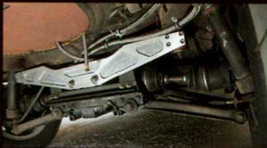
リヤサスペンションはオリジナルのストラット方式を保っているが、各部に補強が加えられるなどされている様子。アルミ削りだしデフメンバーには、NOSMSというブランド名が刻まれていた。
