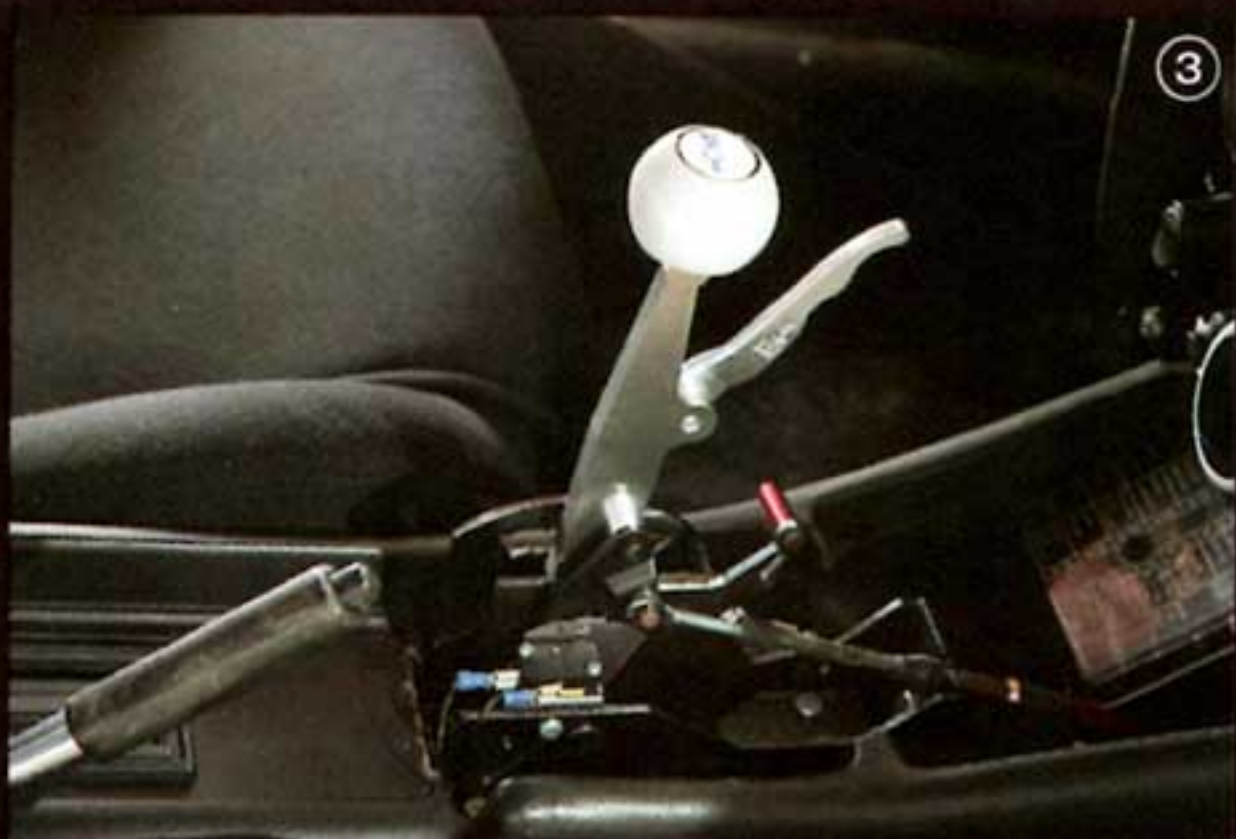
③④ドラッグ用のアメリカ製高強度オートマ。オートマチックと言っても、実際にはシフトセクターはドライバーが動かす。車両は北米モデルのため、レフトハンドーとなっている。
