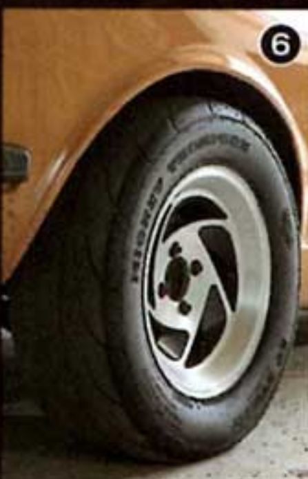
⑤ドラッグスペシャルらしく、フロントには165/80-15という極細タイヤと薄リムのホイール。右フロントタイヤの前に開放されているパイプはなんとマフラー。豪快な仕上げだ。 ⑥リヤタイヤはミッキートンプソンのストリートドラッグ用(ETストリートラジアル)。サイズは235/60-15、このタイヤをはいてゼロヨン12秒台を記録したという。
