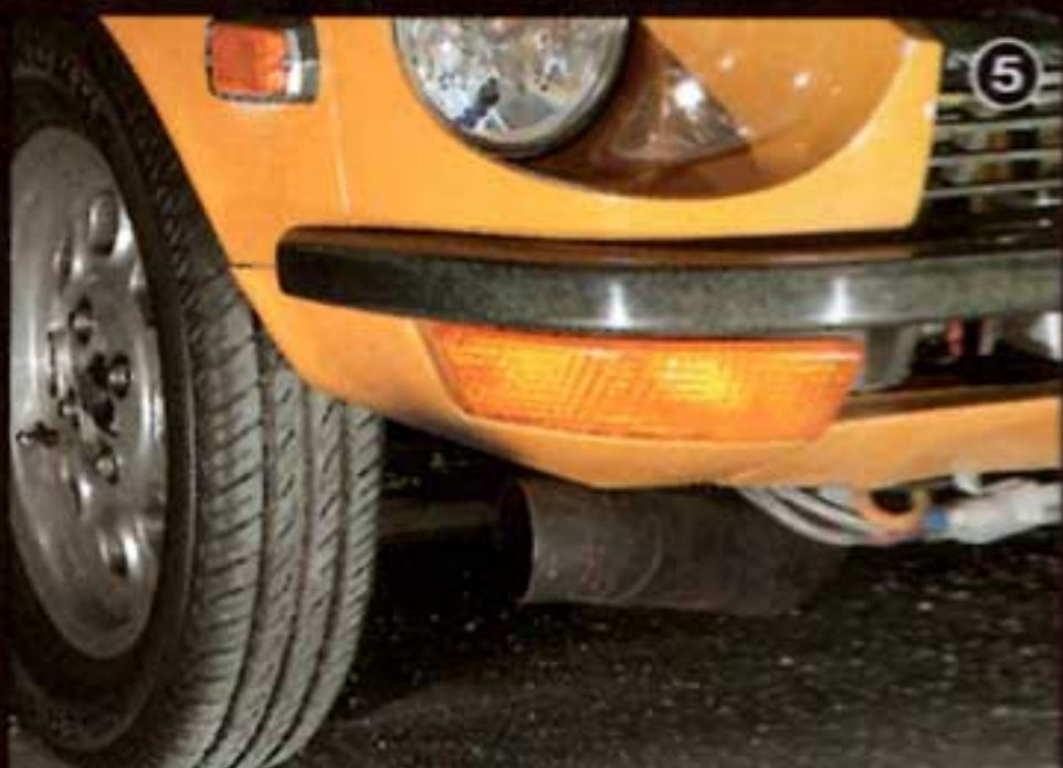
⑤ドラッグスペシャルらしく、フロントには165/80-15という極細タイヤと薄リムのホイール。右フロントタイヤの前に開放されているパイプはなんとマフラー。豪快な仕上げだ。 ⑥リヤタイヤはミッキートンプソンのストリートドラッグ用(ETストリートラジアル)。サイズは235/60-15、このタイヤをはいてゼロヨン12秒台を記録したという。
