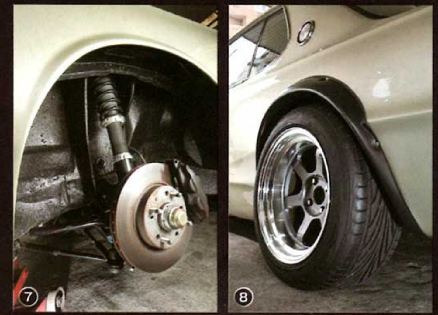
⑦ブレーキはS14シルビアなどに採用されている日産純正4ポッドキャリパー。スタビの強化や車高調の投入、そしてラック&ピニオンのステアリングギヤボックス移植などで操安性能は大きく向上。まるでハコスカとは思えない仕上がりに。⑧ホイールは軽量、高剛性のレイスTE37V。性能やビジュアルにも拘っている。リヤのリム幅は10.5J(-16)。⑨マフラーはあえてデュアル、オーソドックスなビジュアルにもこだわって選択された。
