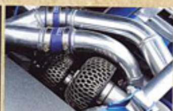
エアクリナーからタービン、そしてインタークーラーを経由して、と複雑なパイピング。このあたりは流用できずワンオフだ。
