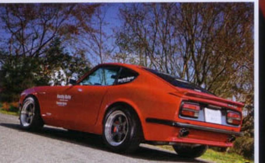
①ベースのL型エンジンは、スーパーchargerで過給する分、圧縮率の高いハイチューン3.1l仕様ではなく、あえてチューンの度合いを抑えたL28型3.0l仕様とした。②ロッキーオート製のカーボンボンネット、バンパー、spoiler、ミラーなどで精悍に仕上げられたエクステリア。③レイズの鍛造ホイールTE37Vに強化ブレーキを備え、メニカルリバートは現代のスポーツカーに負けないレベルへ引き上げられている。
