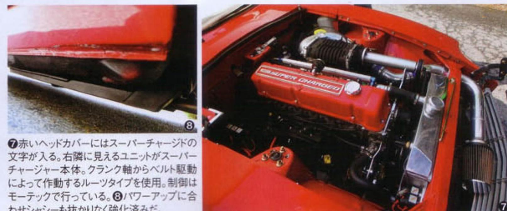
⑦赤いヘッドカバーにはスーパーchargerの文字がある。右隣に見えるユニットがスーパーcharger本体。クラクク輪からベルト駆動によって作動するルーツタイプを使用。制御はモーテックで行っている。⑧パワーアップに合わせシャシーも抜かりなく強化済みだ。
