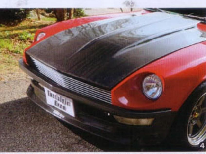
④超軽量なカーボンボンネットは中央に設けられたバルジが特徴となっている。カーボンバンパー&spoilerにビレットグリルを装着。アメリカの香りがほどよくスパイクとなっている。⑤リアスポイラーはリアフェンダーまで回り込む独特の形状。FRP製のほかカーボン製もラインナップする予定。リアのアンダースポイラーから突き出る2本のマフラーは、現代的なスタイリングを取り込んだ。⑥ホイールはレイズが誇る鍛造1ピースのTE37V。フロントブレーキはブレンボ。ちなみにリアはディスク化し、ウィルウッドを投入している。
