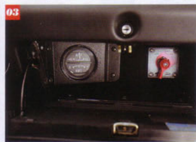
01/レカロのレザーシートと7点式ロールケージが走りイメージさせるが、ロールケージはアルミ製のファッション性を重視したもの。02/メーターはスピード以外社外品。タコはオートメーター、油温、油圧、水温はブリッツ製。ステアリングはダットサンコンベだ。03/グローブボックス内にひっそりと純正の燃料/電流のコンビメーターが移設されていた。隣はキルスイッチ。
