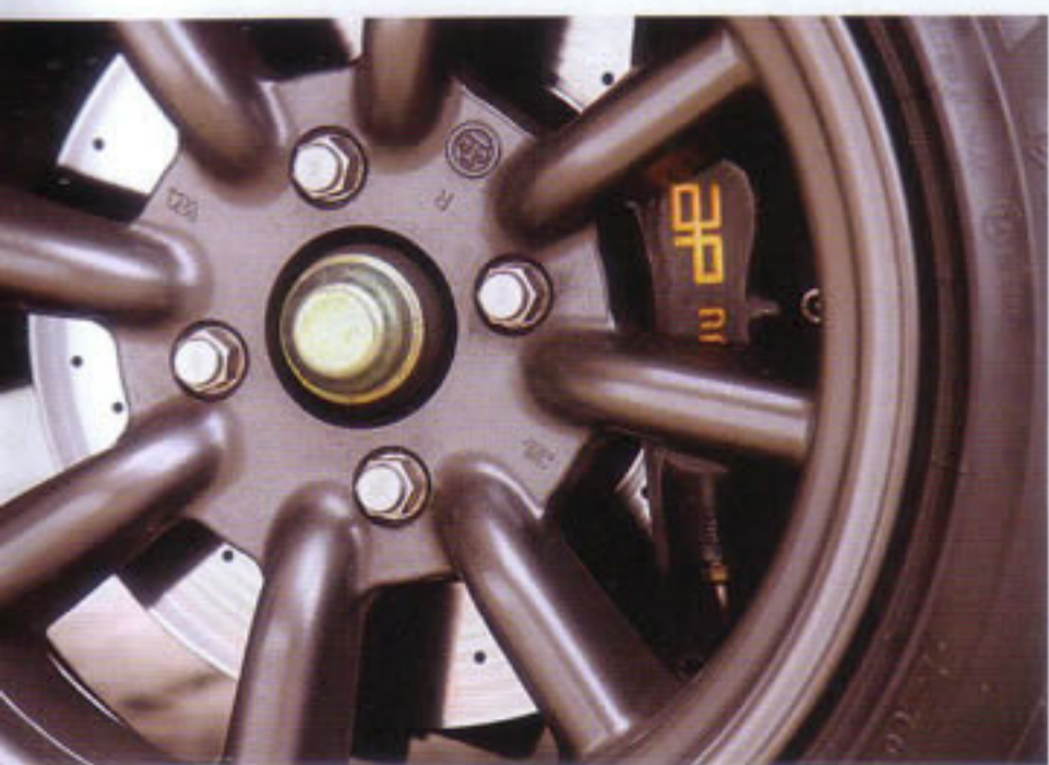
アラゴスタの車高調と相まってAP製4ポットキャリパーの制動性能は抜群。ホイールは定番のRSワタナベの8スポークアルミだ。
