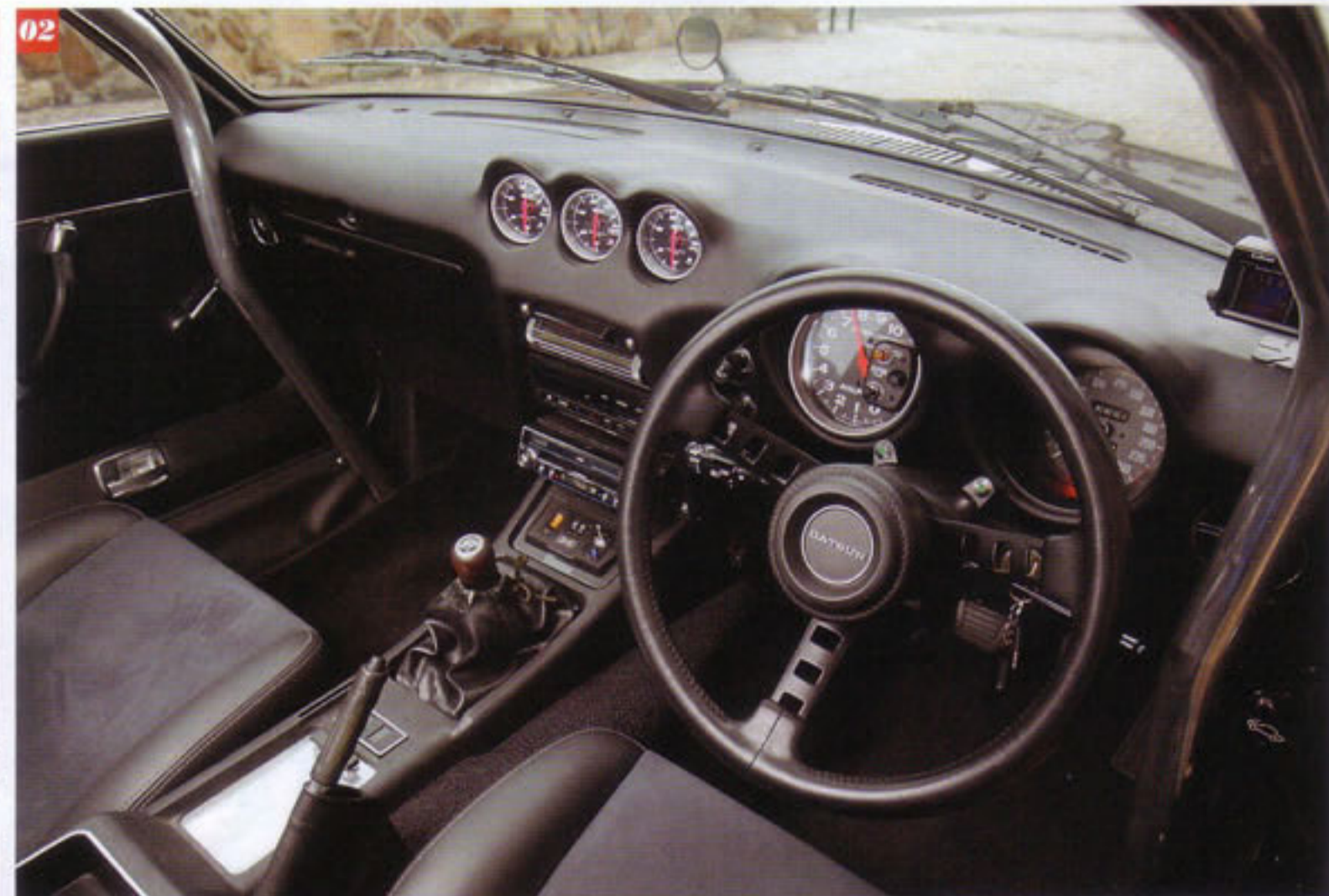
01/レカロのレザーシートと7点式ロールケージが走りイメージさせるが、ロールケージはアルミ製のファッション性を重視したもの。02/メーターはスピード以外社外品。タコはオートメーター、油温、油圧、水温はブリッツ製。ステアリングはダットサンコンベだ。03/グローブボックス内にひっそりと純正の燃料/電流のコンビメーターが移設されていた。隣はキルスイッチ。
