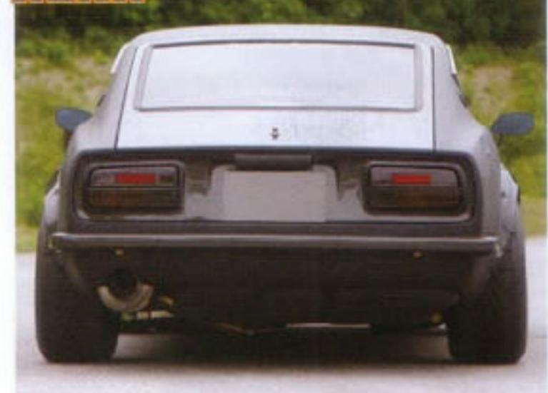
カーボンマテリアルのエアロパーツに交換するのは、チューニングの世界では軽量化の定番。ところがこのZのボディは、前後バンパーを含め文字通り「頭から足の指先まで」カーボンマテリアル。ボディ形状こそそのままだが、艶消しの漆黒ボディが放つ異様なまでの迫力のお陰で、他のZとは明らかに違う印象。ノーマルを遙かに凌駕する剛性に仕上げられたボディは、各所を補強することで重量が増しているが、ボディのカーボン化によって重量増は相殺され、車検証上の車重は1,040kgに抑えられている。フェラーリ458イタリアの1,580kg、R35GT-Rの1,730kgと比較すれば、カーボンZがどれほど軽いかが理解できるだろう
