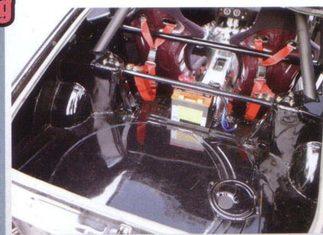
スペアタイヤハウスが無いラゲッジスペースは、レース仕様で限定のZ432Rを彷彿させる。各接合箇所はスポット増しがれ、ロールケージもボディと溶接することで、純正とは比較にならないボディ剛性に仕上がっている
