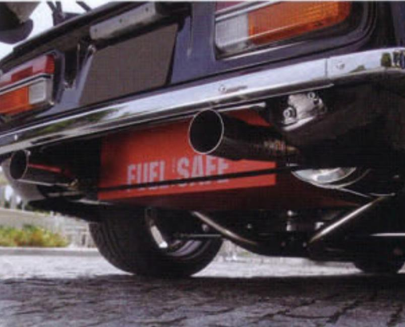
ラゲッジルーム下のスペアタイヤ装着位置を加工して、レース用の安全燃料タンクを装着。実際の性能だけではなく、バンパーの下に見える赤いタンクの存在が迫力。両サイドから出るツインマフラーは、排気効率だけではなく、後方から見た際のインパクトをさらに引き立てる効果も狙っている。
