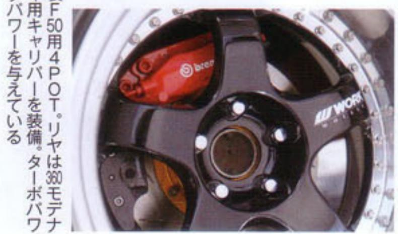
フロントキャリバーはブレンボ製F50用4POT。リヤは300モーテナ用4POTと共にサイドフレーキ用キャリバーを装備。ターボパワーに負けない強靱なストッピングパワーを与えている
