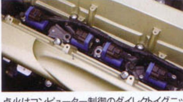
点火はコンピューター制御のダイレクトイグニッション。RB26に純正採用されている物を、さらに強化して失火対策している
