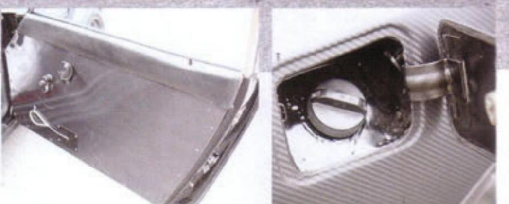
ドアの内張りも純正の内装ではなく、カーボンの一枚板で仕上げられている。純正の燃料タンクは金属製だが、現代の樹脂製タンクに交換することで大幅な軽量化を実現。タンク内に収められた現代的な燃料ポンプを使うため、ポンプ音や燃料臭も無く意外にも快適が高い
