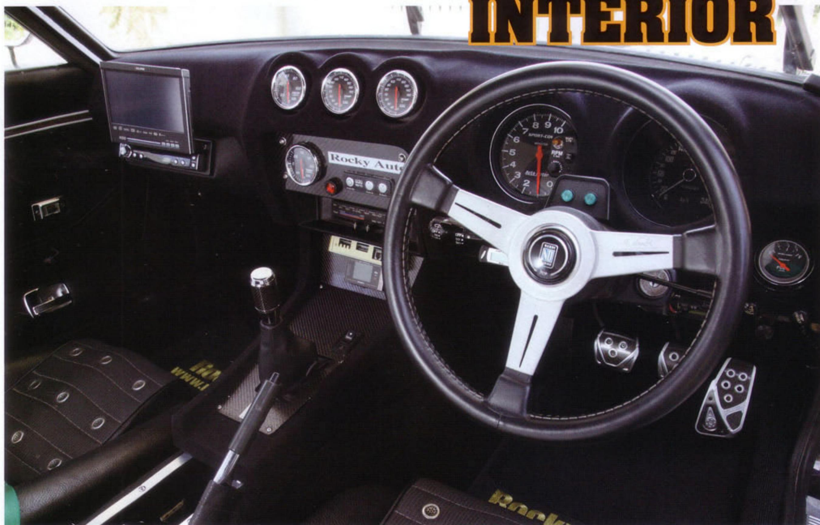
Zの雰囲気を残しつつ、1DINインダッシュナビや現行日産車の空調スイッチが並ぶ室内。センターパネルにはHKS製ブーストコントローラーのEVCや、エンジンマネージメントのFコンバプロが取り付けられている。3連メーターは左から油圧、油温、水温で、その下にあるのがブースト計。ステアリングの右側にはオートメーター製の燃料計が取り付けられる。
