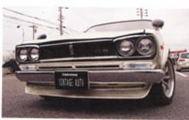
フロントの巨大なリップスポイラーは、並行安定性と車体裏の空気超抗 低減、エンジンルームへ冷却効果を向上させる。
