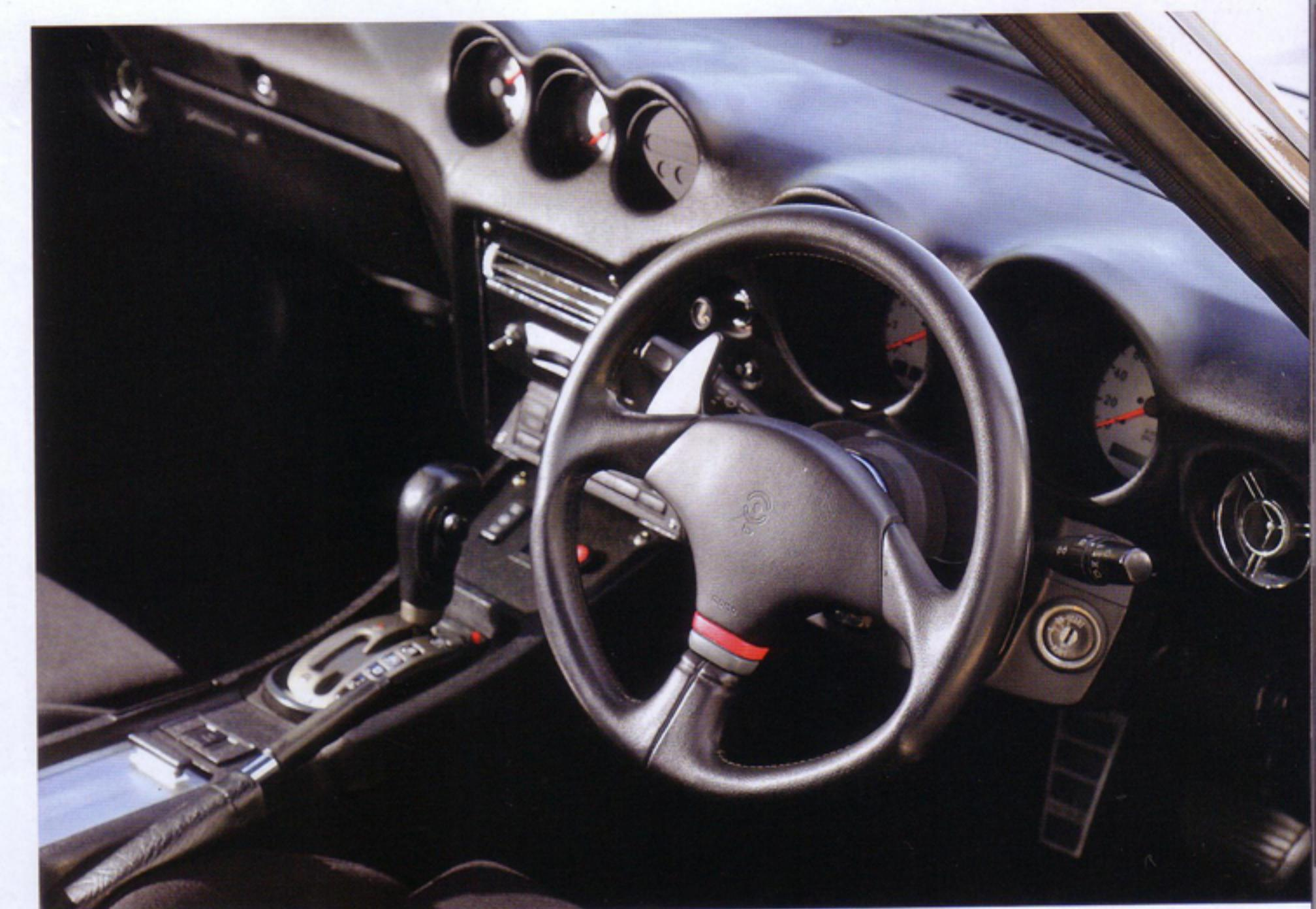
3連メーターを入れ替えてステアリング、メーター、スイッチ類を変更。大きく異なるのがシフトゲートとステアリング裏のパドルシフトといえる。
