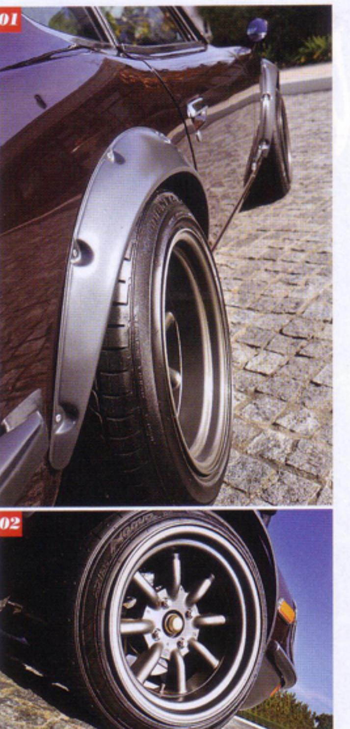
01／前後のオーバーフェンダーを有効に生かすためフェンダーのツメは折り曲げられ、極太タイヤを収めている。ボディの塗装も極上のレベルに仕上がる。02／ホイールはRSワナベでフロントが9J、リアが9.5J。エンジンパワーに対応すべくフロントブレーキはタイプMキャリパーにスリットローターを組み合わせる。
