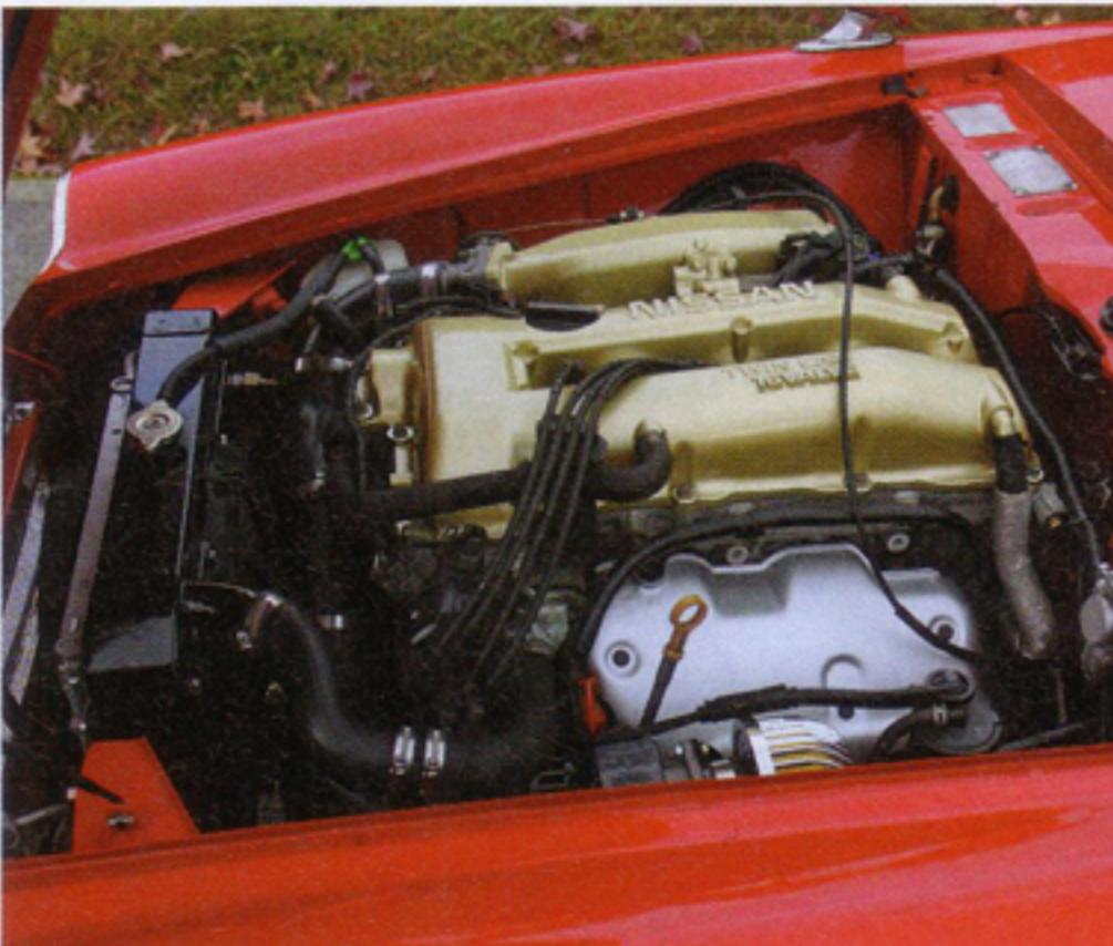
←コンバートされたエンジンはニッサンのSR20DE。1990年代から2000年にかけて多くのミドルクラスに搭載された1998ccのDOHCで、165馬力を発生する
