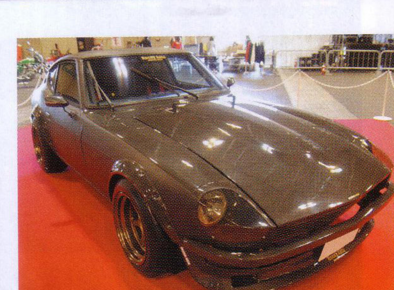
全身カーボンのS30は、輸出用RB30ブロックにツインカムヘッドを搭載したモンスター
