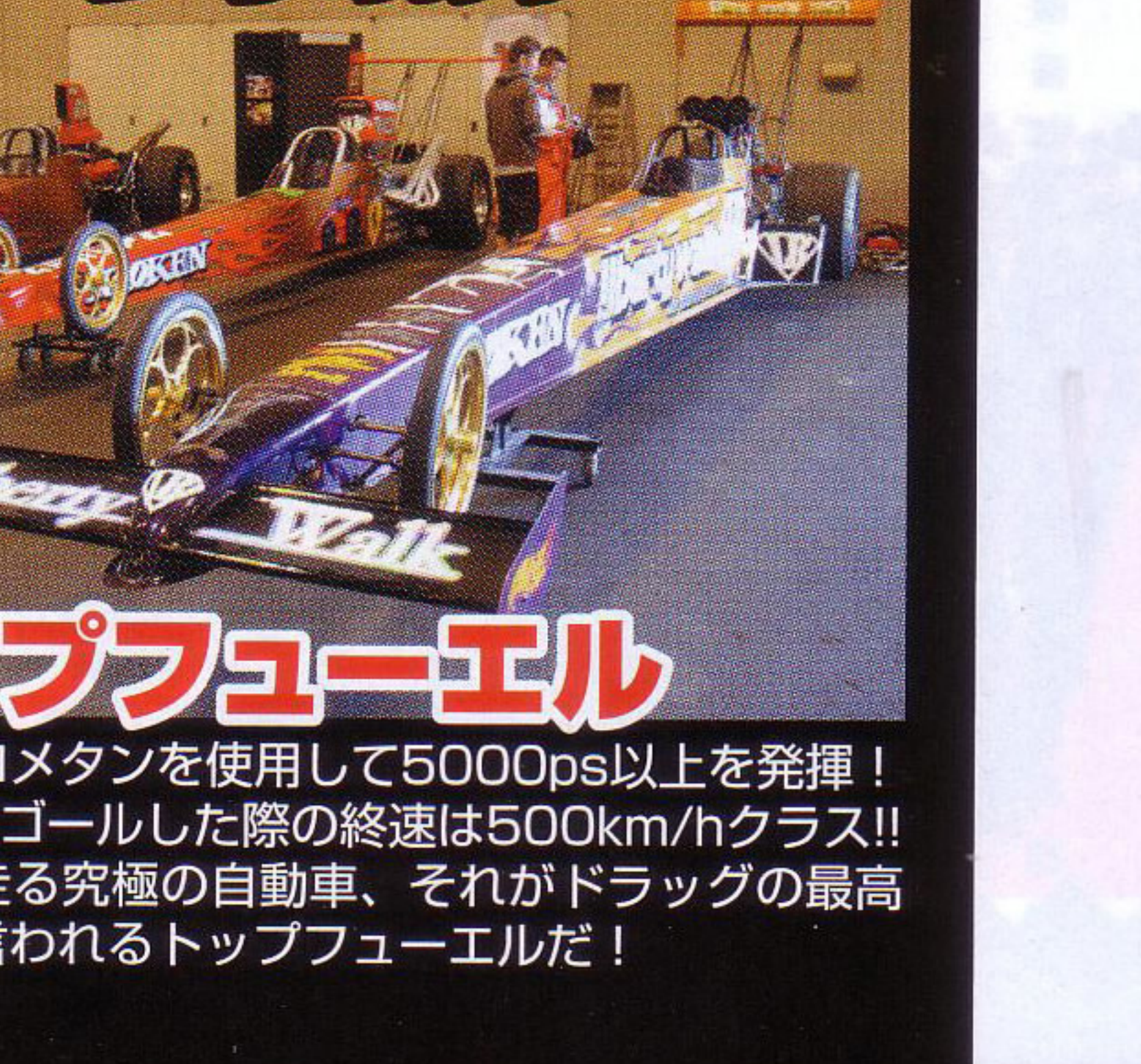
トップフェューエル ナイトロメタンを使用して5000ps以上を発揮! 4秒台でゴールした際の終速は500km/hクラス!! 地上を走る究極の自動車、それがドラッグの最高峰ともいわれるトップフェューエルだ!
