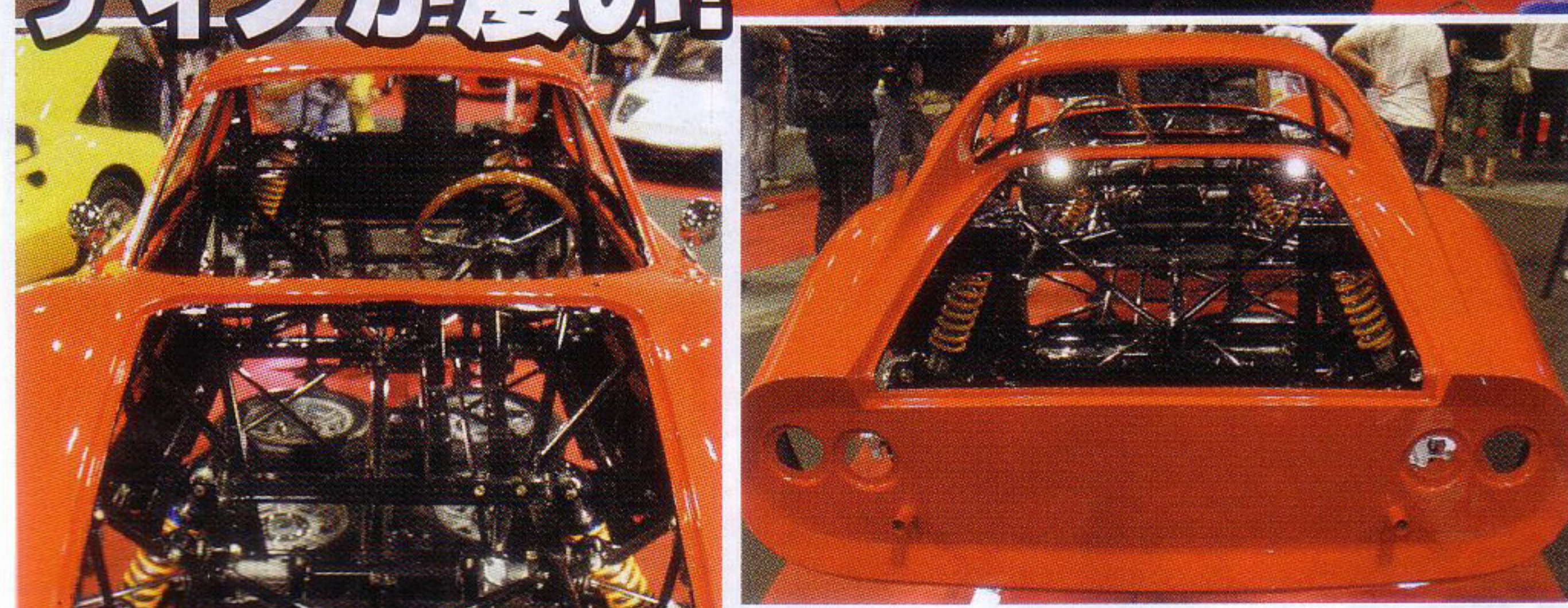
完璧にレストアされたフレームに、ボディカウルを載せただけの状態で展示されていたディノ
