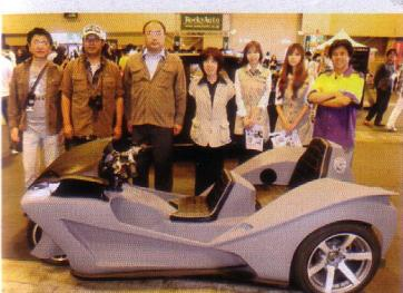
●アルミ板金、FRP成形、フレーム製作を手がける愛知の鬼オビルダー、村手智一さんが設計製作した250ccトライク「MURATE」(プロト)。これまでのトライクにはない低いプロフィールと操縦感覚が特徴。販売予定価格は88万8000円(リヤリジッドタイプ)。
