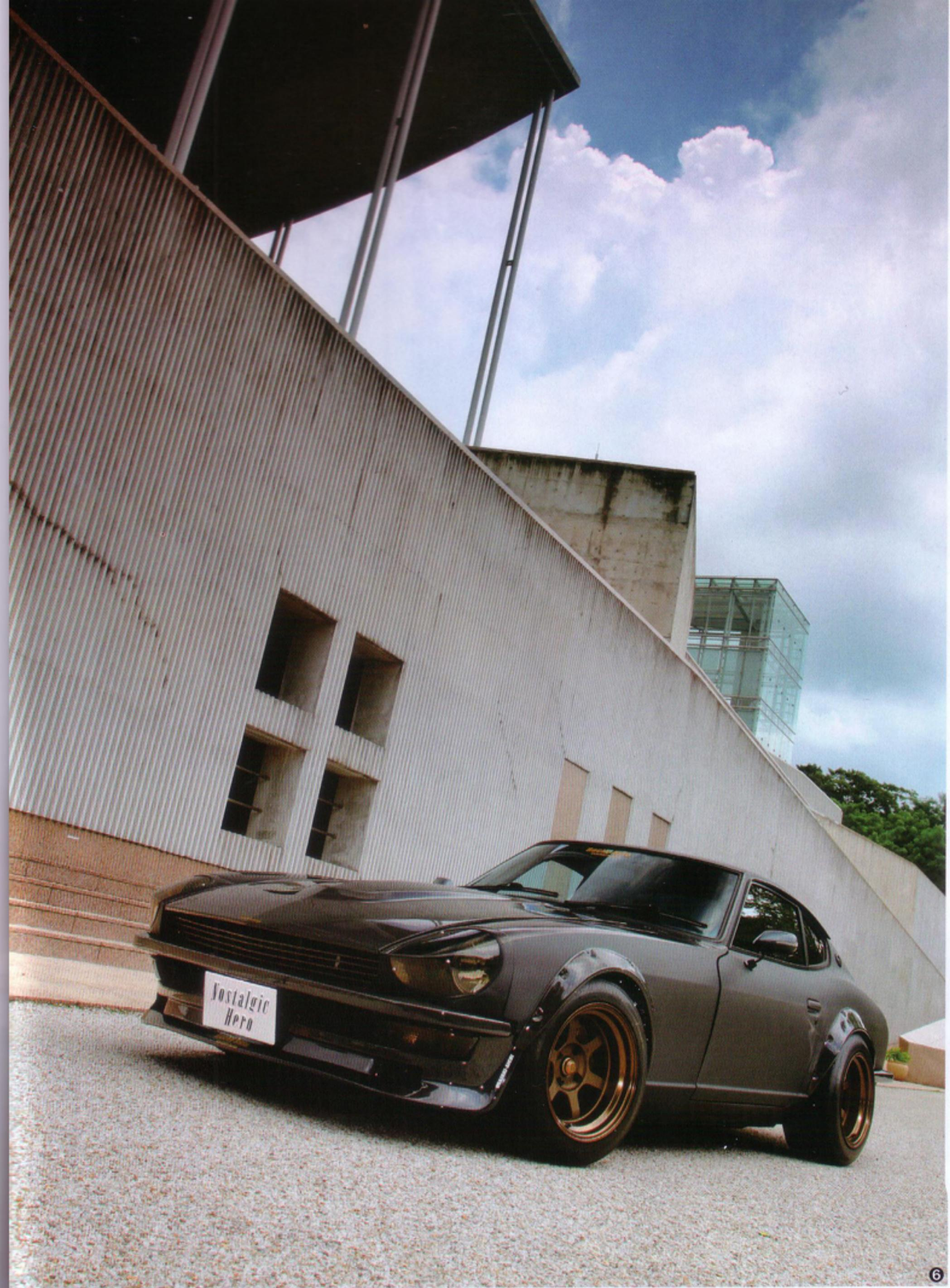
①Fバンパーとスポイラー、ボンネット、ヘッドライトベゼル＆カウルトップをドライカーボン化。②フロントフェンダーとオーバーフェンダーもカーボン製を装着。ホイールは軽量鍛造ホイールのヴォルクラーシング・TE37Vだ。③リアハッチもドライカーボンに。この部分の軽量化はハンドリングにも大きな影響を与える。クルマの動きがクイックかつダイレクトに変わる。④ガリソンタンクも樹脂製へと交換。リアオーバーハングのバーツを軽量化することでコーナーでの回頭性が格段に向上了した。⑤リアのオーバーフェンダーもカーボン製。リアフェンダーはドア、ルーフと合わせてカーボン調に仕上げられ、全体のバランスを整える。タイヤはリアに225/50R15を履く。最先端の超軽量・高剛性1ピース鍛造ボイールに、昔のレーサーっぽく引っ張り気味にしてタイヤを履かせているのも、最先端のテクノロジーとスタイルがテクニカルなテイストを絶妙に組み合わせている部分。⑥ロールケージや大幅なボディ補強、RB30搭載と重量増になるはずのモディファイを施しているのに車重は1040kgを達成。カーボンボディによる軽量化が絶大な効果を發揮している。
