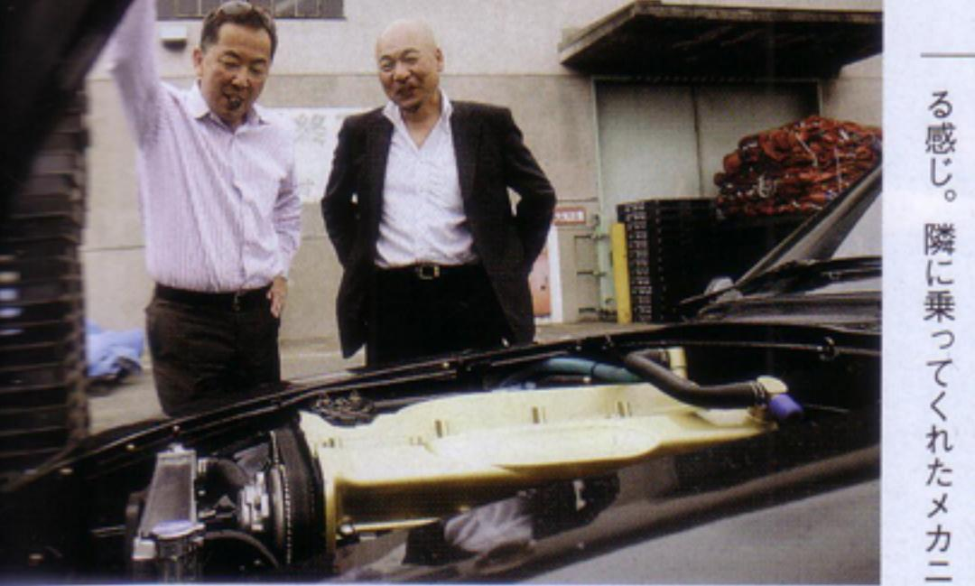
N.A仕様にリファイン。吸排気系はソレックスの50パイに等長ステン6-1エキマニとかなりヤル気。しかもボディはカーボン。シャシー全般もエンジン搭載位置(フロントミッド化)含め大幅にブラッシュアップされている。シリンドラーハードウェイを攻めた時よりも刺激的だ。中で燃料が爆発しているのがリアルに感じられる。アクセルの開度で燃料を込められた。隣に乗ってくれたメカニックさを感じ。隣に乗ってくれたメカニックさ
