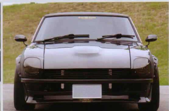
漆黒のボディの正体は、全身カーボン。前後バンパー、フロントスポイラー、フロントフェンダー、ライトベゼル、ボンネット、オーバーフェンダー、リアゲート、ガーニッシュ、リヤゲート、リヤフェンダーに続く面は、ボディにカーボン繊維を貼り込むことで、他のZとは全く異なる威圧感を放つ。車体の完成度は現状で8割。これから細部を煮詰め、走りに磨きを掛けていく予定だ
