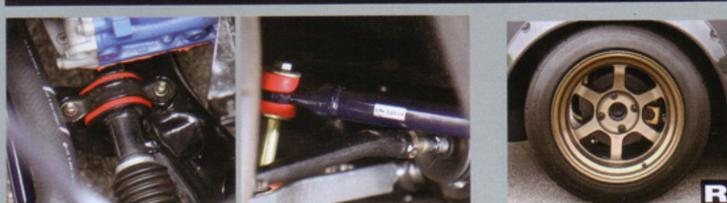
オリジナルの車高調を組み、ARC製のバイスタビライザーを装着。同時に各ブッシュを強化品にすることで、ステアリングのシャープな応答性を実現。ロアアームとデフメンバーは、オリジナルのアルミビレット製だ
