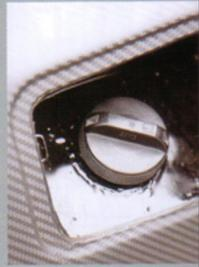
ステージア用の68ℓ燃料タンクに交換して、現代のインク式燃料ポンプを装着。ボアの首やガソリン臭が室内から、樹脂製なのでサビとも無。フェルリッドにはネジキャップが付く
