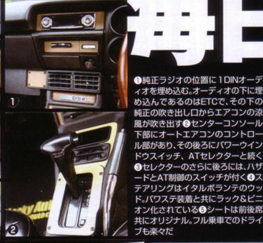
①純正ラジオの位置に1DINオーディオを埋め込む。オーディオの下に埋め込んであるのはETCで、その下の純正の吹き出し口からエアコンの涼風が吹き出す②センターコンソール下部にオートエアコンのコントロール部があり、その後ろにパワーウィンドウスイッチ、ATセレクトと続く③セレクトのさらに後ろには、ハザードとAT制御のスイッチが付く④ステアリングはイタルボランテのウッド。パワステ装着と共にラック&ピニオン化されている⑤シートは前後席共にオリジナル。フル乗車でのドライブも楽々だ
