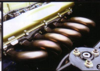
①RB系で最も排気量の大きい輸出用RB30。排気量は大きいものの、ヘッドはシングルカム2バルブなので、270度カムを組んだRB26のツインカムヘッドを組み合わせて搭載。ミッションは、OS技研製3速クロスが組まれた71C。駆動系はクスコのLSDと等速ジョイントにて強化済みだ②点火はコンピューターで制御しているが、燃料供給はソレックス50φキャブレターにて行うため、加速と共にキャブの吸気音も楽しめる③タコ足はオリジナルの48φ等長の6-1レイアウト。繋がる排気音は格別だ
