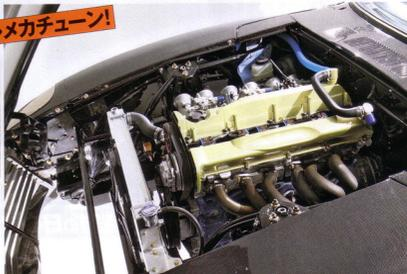
ミッションのトンネルハウスを大幅に加工作してオフセット装着されたエンジンは、輸出用の3.0エンジン・RB30に325匹のヘッド台合せドロクオート自働の部品、シランピンゴールに彫られたカムシャフトも美しいこのエンジンにプロレックスの50キヤブオシノールのハイカムをコンバート。低速から滑きあがるトルクフルな特性を獲得!! でも、もちろんハイカムがリリミック4000回転からは、文字通り暴力的な加速力も体感できるのだぞ!
