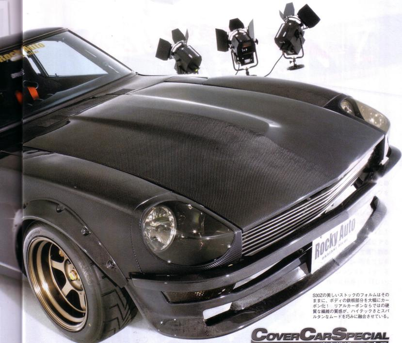
S30Zの美しいストックのフォルムはそのままだに、ボディの鉄板部分を大幅にカーボン化!!! リアルカーボンならではの緻密な織物の質感が、ハイテックとスーパーランナムードを巧みに融合させている。
