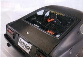
ストックのウィンドーを収めたリアハッチやリアガラスも、もちろんイチから型を取ってリアルカーボン化!!! 細部の形状や複雑な形も忠実に再現し、抜群のフィッティングを見せつける。
