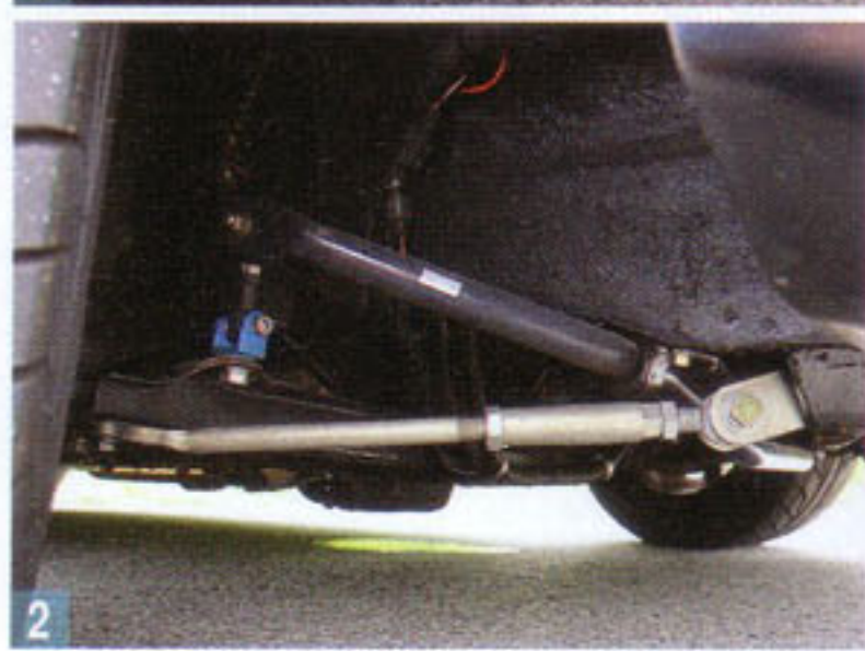
1.マフラーはφ50のステンデュアルタイプ、ロッキーオートのオリジナルだ。2.パワフルなエンジンもしっかりとした足周りがなければ楽しむことはできない。サスは前後共アラゴスタの特注を装備するほか、調整式のテンションロッドやレース用の中空ARCスタビライザーなどによって強化されている。3.ゴージャスなGTカーに相応しいレカロがよく似合う。
