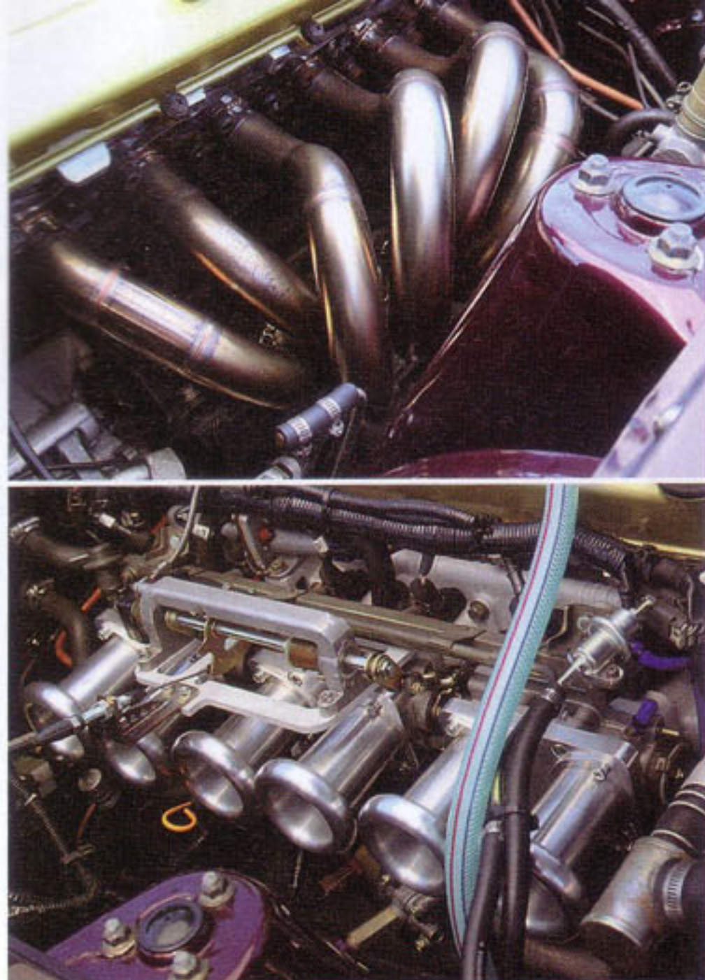
ボンネットの下にはメカ好きが見ればヨダレを垂らしそうな魅力的なコンポーネントが鎮座する。複雑に手曲げされたオリジナルの等長ヘダースや、熟成の域に達した6連スロットル、スポーツインジェクションのボディが眩しい。まさにネオクラシックの名に相応しい光景だ。
