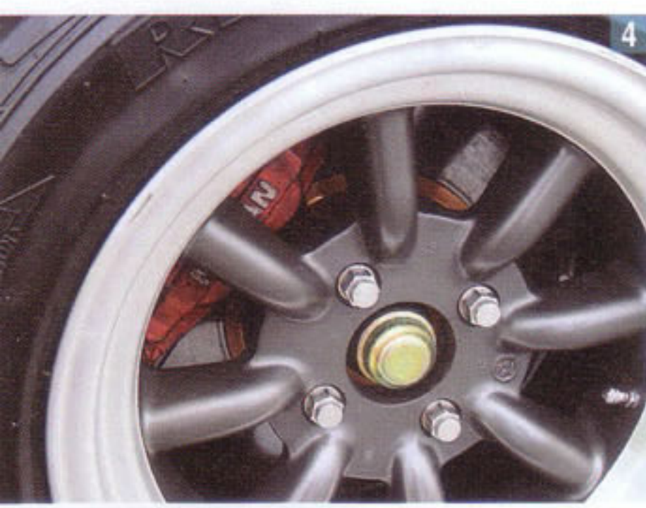
1.ワークススタイルといえは不可欠なのがこの巨大なオイルクーラー。もちろん内蔵も可能だが、あえての演出だ。2.これもワークス的演出のひとつ。ピストン本まできれいに仕上がっているのが印象的だ。3.大きく張り出したワークスフェンダーに面を合わせるとなると超深リムも必須。リアタイヤは275/50-15を履く。4.フロントブレーキはタイプM4キャリパーを装着、リアはDR30のディスクブレーキを装着して強烈なストッピングパワーを確保する。
