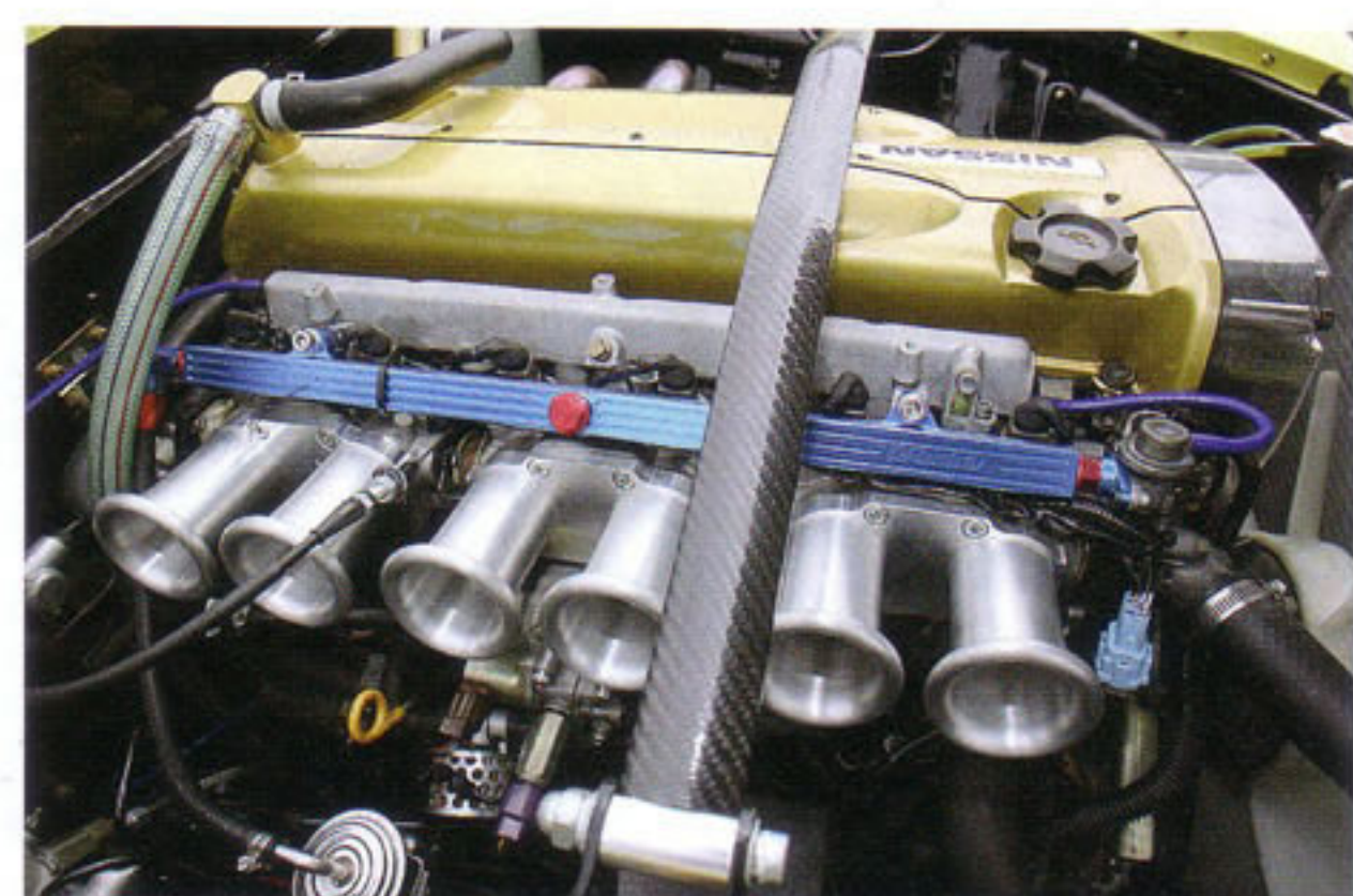
今回のプロジェクトの主役はなんといってもこのエンジン。RB30にRB26D ETTヘッドを組み、6連スロットルで武装したモンスターだ。
