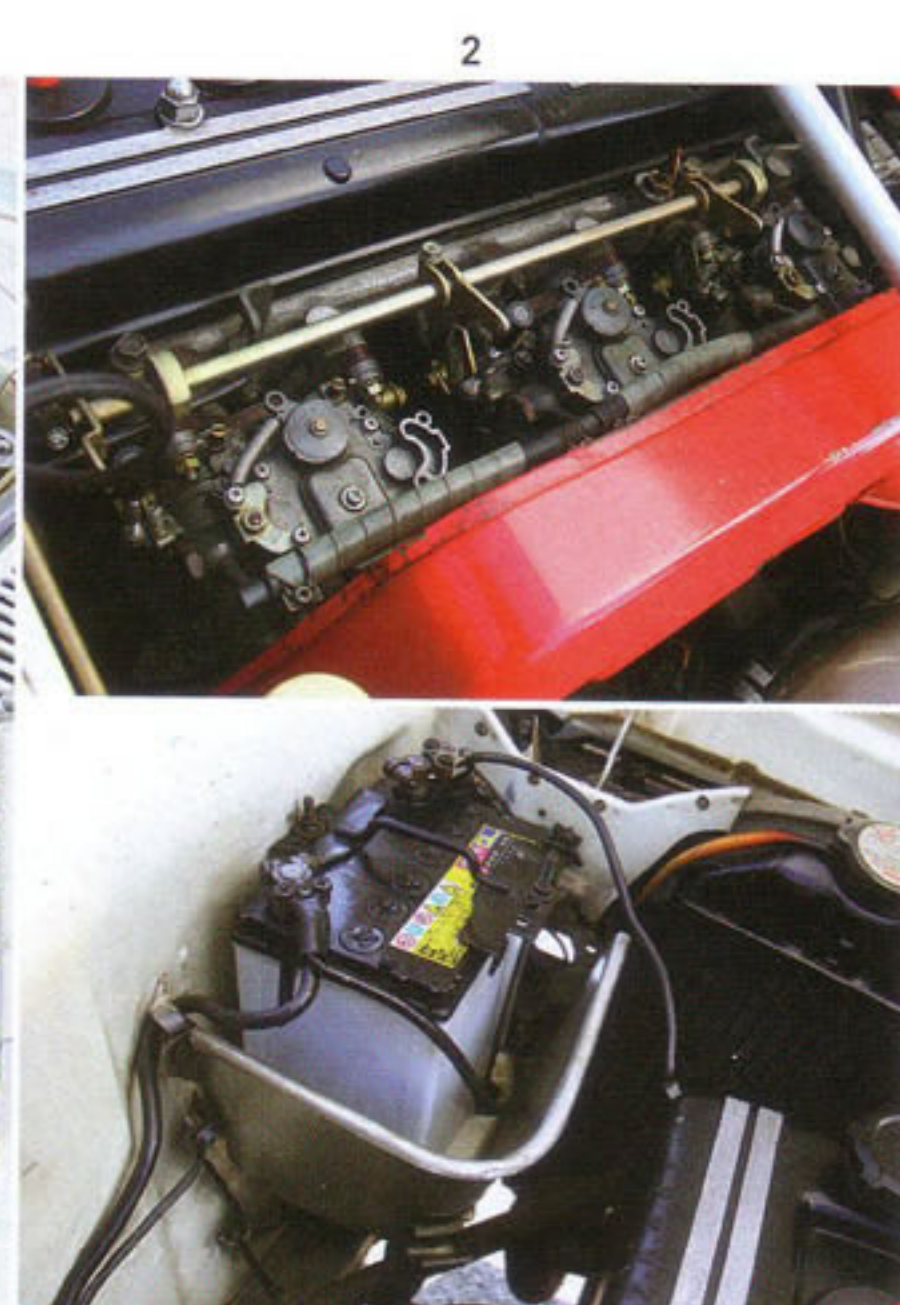
1.フロントタワーバーが装着されていることを除き、至ってノーマルなエンジンルームはコンディションも上々。赤いエアリーナーボックスとプラグコードが目玉。2.エキマニの熱からバッテリーをガードするアルミ製ヒートシールドは、クロスフローのS20エンジンを搭載するGT-Rだけに付属。3.ハイスペックなS20エンジンには純正で3連のミクニソレックスN40PHHが装着される。
