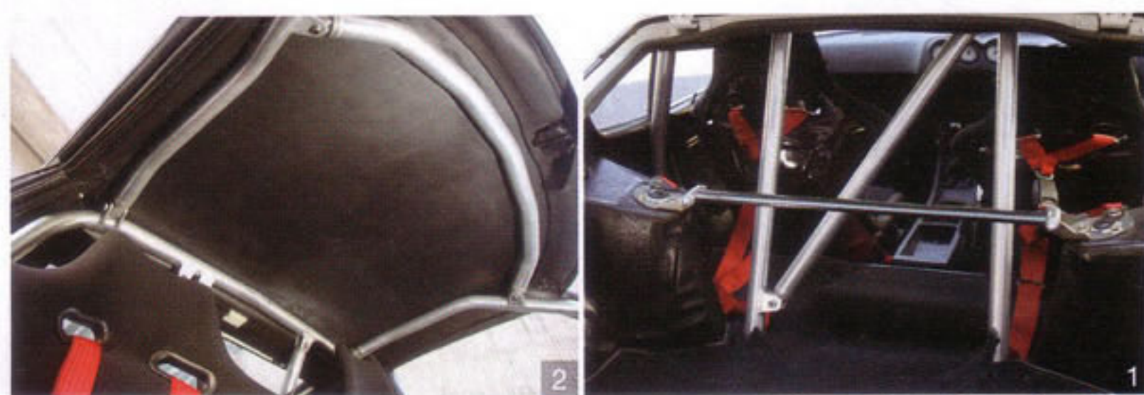
1,2.本格的なサーキットランにも対応するべく室内にはアルミの7点式ロールケージがレイアウトされる。3.マフラーはステンレス製のオリジナル。ちなみにエキゾーストマニとタービンアウトレットパイプもステンレス製である。4.エンジンコンパートはもちろん、クルマのことなら何でもござれのプロショップ、ロッキーオートを主宰する渡辺氏。
