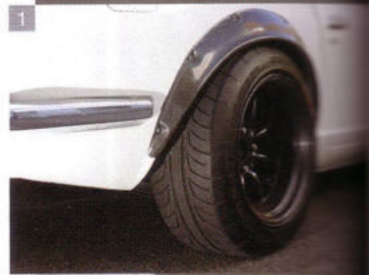
1.ホイールはRSワタナベでフロントが8Jでリアは9J。タイヤサイズはフロントが205/50-15で、リアが225/50-16となっている。前後のオーバーフェンダーの張り出しに合わせて理想のトレッドを追求した結果であるという。2.エンジン、足回りの高性能化に合わせて当然ながらブレーキもニッサンモダンなニッサン純正パーツを使って強化されている。3.サイドマーカ―はフェラーリ360モデナの純正パーツだ。
