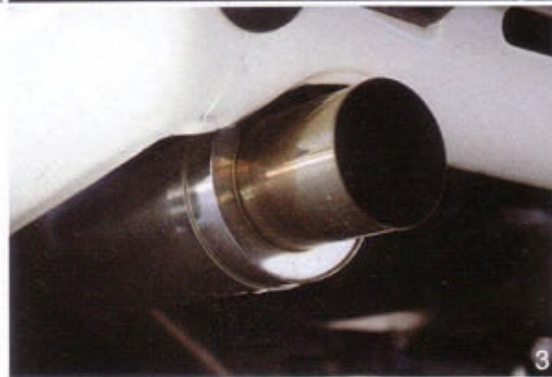
1,2.本格的なサーキットランにも対応するべく室内にはアルミの7点式ロールケージがレイアウトされる。3.マフラーはステンレス製のオリジナル。ちなみにエキゾーストマニとタービンアウトレットパイプもステンレス製である。4.エンジンコンパートはもちろん、クルマのことなら何でもござれのプロショップ、ロッキーオートを主宰する渡辺氏。
