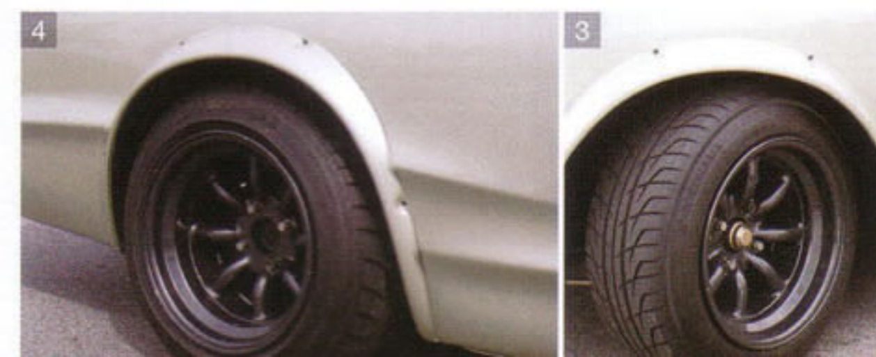
1.スロットルボディに装着されたきれいなアルミファンネルはスーパースポーツL型が全域でトルクフルなパワーを発揮するための重要な要素。2.各プラグにそれぞれ1個ずつのイグニッションコイルがダイレクトに装着されている。RBエンジンの純正パーツの流用だ。3.4.有り余るパワーと強靱なボディのポテンシャルを活かすために装着されたタイヤはフロントが195/55-14、リアが225/50-15となっている。
