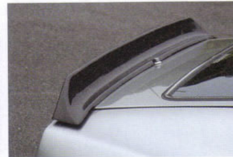
形状はオリジナルに近いが、カーボン製としたリアスポイラー。さりげなく現代の素材を使用している。
