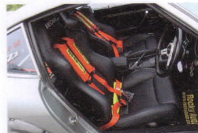
シートはホールドを増したレカロのバケットタイプを装備。オリジナルのシートではやはり、このクルマには心許ない。
