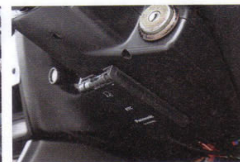
ステアリング下にはETCのユニットをさりげなく装着。高速道路を利用時のクルージングにはやはり便利だ。
