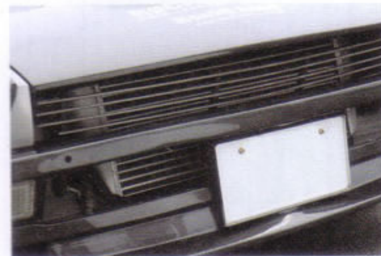
フロントには大型のインタークーラーが見える。ツインターボで武装したエンジンのすごみが伝わる。
