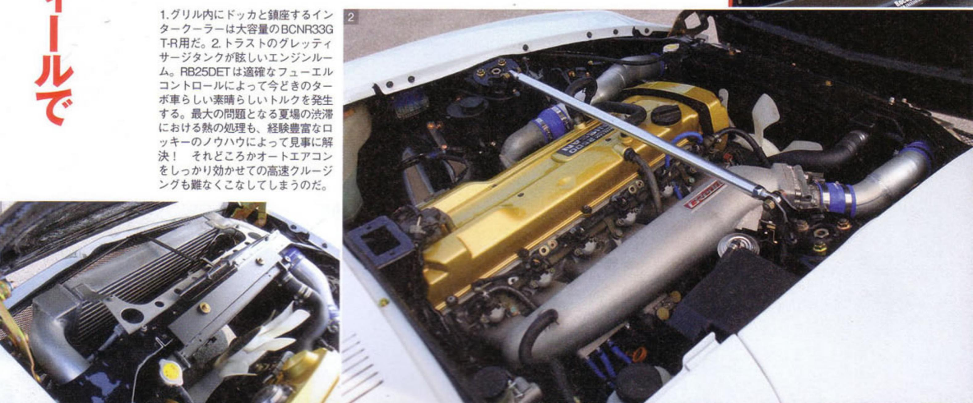
リル内にドッカと鎮座するインクーラーは大容量のBCNR33G用だ。2.トラストのグレッティタンクが眩しいエンジンルームRB25DETは適確なフューエルトロールによって今どきのタラらしい素晴らしいトルクを発生。最大の問題となる夏場の渋滞における熱の処理も、経験豊富なローのノウハウによって見事に解。それどころかオートエアコンっかり効かせての高速クルージングも難なくこなしてしまうのだ。
