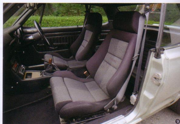
⑨ シートはレカロのリクライニング・タイプを装着し、ポジションの自由度を得るとともに快適性も確保。シートベルトもELR付き3点式が装着される。⑩ インパネはほぼオリジナルながら、中央にはオートエアコンの操作パネルが加わり、ステアリングもナルディのクラシックに交換。パワーアシスト付きなのでφ36mmでも楽々と回せる。
