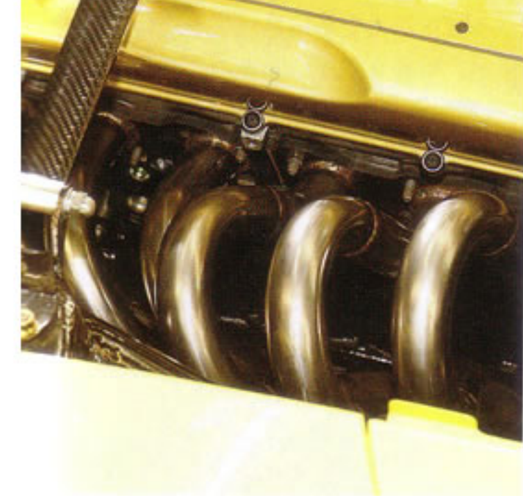
RB30改のエンジンをマウントすると、そのヘッドはご覧のようにギリギリの高さとなる。もちろん通常のフォルムを崩すことなく、きっちりクリアランスを確保しての搭載だ。このあたりの技術にロッキーのエンジンコンパートに対する深い経験が活かされている。
