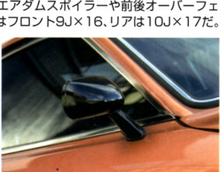
▲純正はもちろんフェンダーミラーだが、ドアミラーに変更。足の長いタイプを用いることで視界を確保している。
