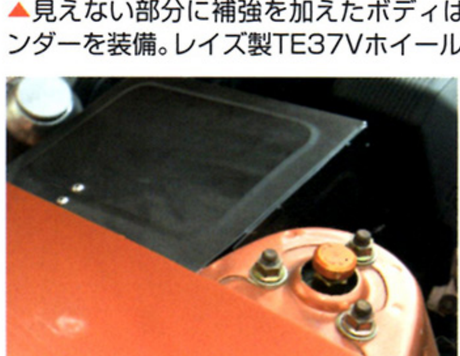
▲フロントはピロアッパー式の全長調整式サスペンションを装備。1UZのコンピュータ類を黒いパネルでカバー。
