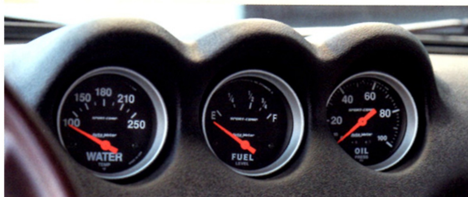
▲速度計は純正だがタコメーターや写真の3連メーターはAutometerに変更されている。
