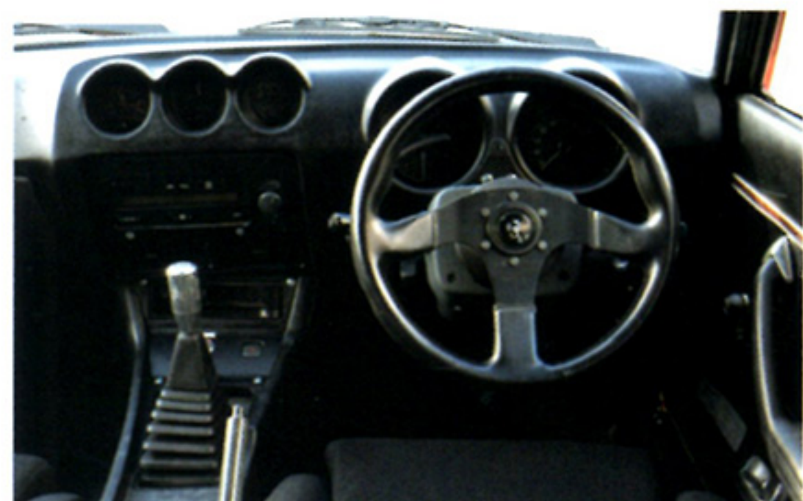
▲純正ダッシュボードにイタルボランテ・ステアリングを装備。ステアリングコラムはトヨタ製で1UZ用ハーネスを移植。電装系の改造がキモ。
