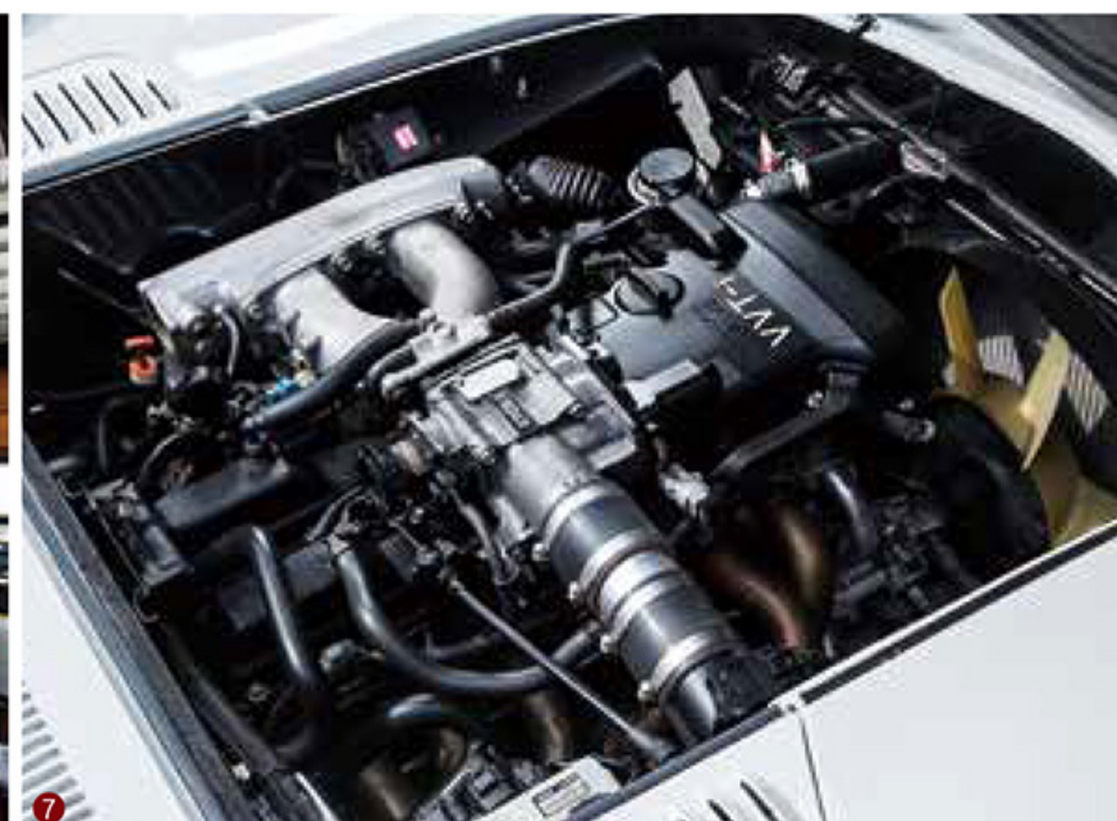
7 エンジンには2JZ-GE型。直列6気筒DOHC24バルブで排気量は2997cc。2JZ型の第二世代で可変バルブ付きのVVT-i仕様。140~150系のクラウンにも使われた名機。8 量産されている3000GT。納期は必ず守ると明言。予約順もしっかり守られている。
