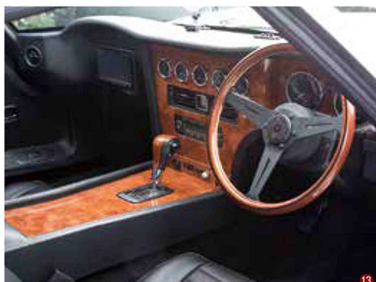
11 シートは当時のデザインを踏襲し、より肉厚に。ヘッドレストも装備されている。12 パワーウィンドウを装備。13 ウッドの内装は2000GTのオーラを出した質感。エアコンの吹き出し口も目立たないように工夫。サイドブレーキはステッキ型をそのまま使えるようにしている。
