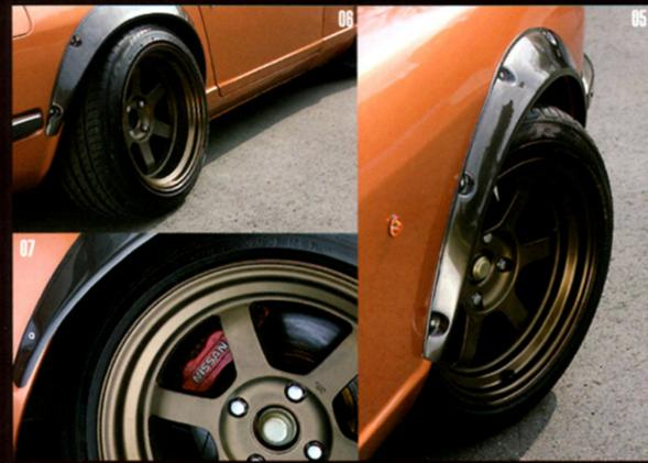
05 / エンジンパワーを犠牲にしないため、アルミホイールは軽量のレイズ製 TE37V をチョイス。フロントは9J×16サイズながらフェンダー内に収まる。
