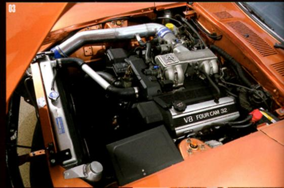
03 / 1UZエンジンを載せるため後期S31ボディを使いセンターフレーム、ステップに補強を加えパネル溶接を施している。ミッションは走りの5速だ。
