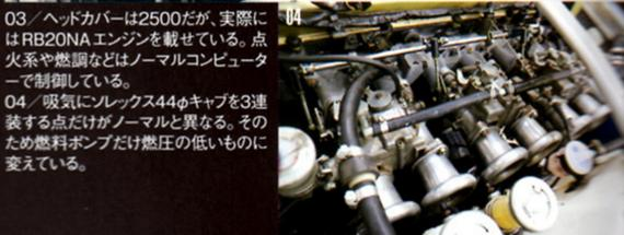
03 / ヘッドカバーは2500だが、実際にはRB20NAエンジンを載せている。点火系や燃調などはノーマルコンピューターで制御している。04 / 吸気インレックス44φキャブを3連装する点だけがノーマルと異なる。そのため燃料ポンプだけ燃圧の低いものに変えている。
