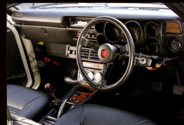
02 01 / ドアを開けて運転席に乗り込んでもGT-R仕様そのまま。旧車を楽しむのだから、運転中に新しいものは存在しない方がいい。02 / わずかにセンターコンソールへ3連メーターを追加しているのが新しさを感じるポイント。上のスイッチパネルでエアコンを始動させる。
