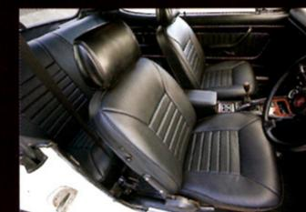
フロントシートもあえて最新のバケットなどは入れず純正の表皮を張り替える手間をかけている。純正志向の人には最適だ。
