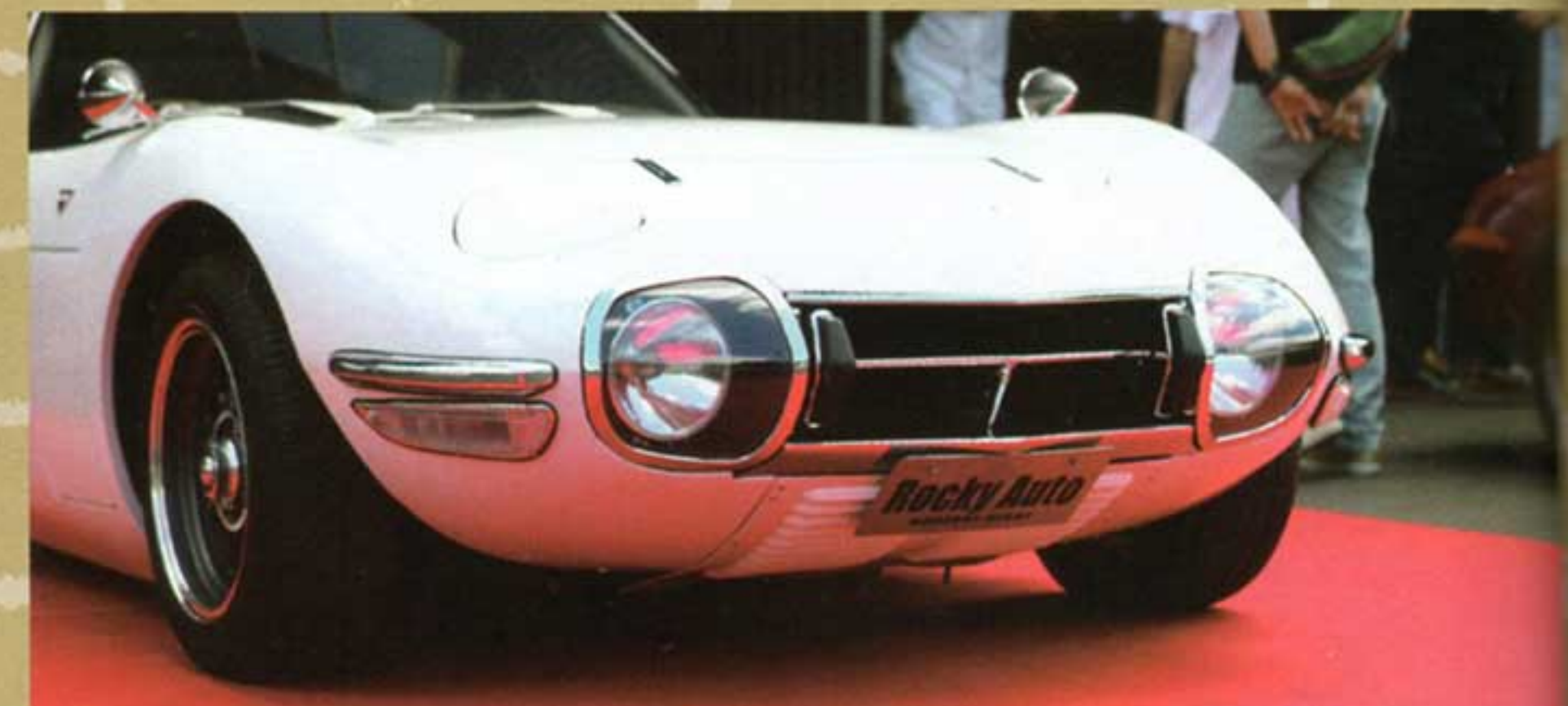
▲ロッキーオートRHVの時とはFFでどうしても前のタイヤ軸より前にかたまりが来ってしまう構造と、エンジンの全高もあつたため前から見るとエンジン下部が少し見えてしまう感じだったが、今回の3000GTはエンジンは縦積みのため前から見てもスマートに見える
