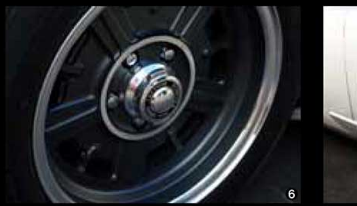
①エンジンルームには2000GTと同様の水冷直列6気筒DOHCとなる2JZ型を搭載。排気量は3ℓとなり、1気筒あたり4バルブを備え、可変バルブタイミング機構も備えた高年式エンジンとなる。②ルーフも特徴的なダブルバルブを忠実に再現。少しでも前面の投影面積を削りたいため、中央部分のみルーフラインを低くする工夫だ。③リアのハッチゲートも可動。2段式のストッパーを備えている。カーゴスペースも確保されている。④オリジナルの2000GT同様に、左フェンダーのサービスハッチを開けるとエアクリナーが顔を出す。⑤同様に右サイドにはバッテリーを搭載。オリジナルでは装着されていないハッチのストッパーが付いている。⑥センターロックデザインを巧みに落とし込んだ5穴ホイール。製品版とデザインは同様だが、鍛造削り出しで作られた試作品のため、リム幅が7Jとなっており、05Jほど幅広となっている。⑦剛性の高いパイプフレームに軽量なFRPボディという組み合わせは、レーシングカーの文法通り。走りの性能も十分。
