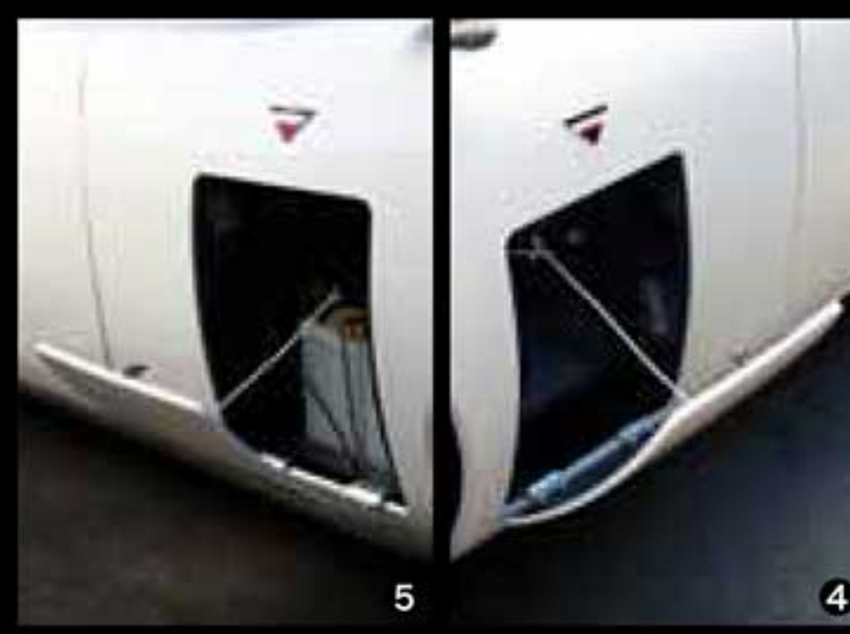
①エンジンルームには2000GTと同様の水冷直列6気筒DOHCとなる2JZ型を搭載。排気量は3ℓとなり、1気筒あたり4バルブを備え、可変バルブタイミング機構も備えた高年式エンジンとなる。②ルーフも特徴的なダブルバルブを忠実に再現。少しでも前面の投影面積を削りたいため、中央部分のみルーフラインを低くする工夫だ。③リアのハッチゲートも可動。2段式のストッパーを備えている。カーゴスペースも確保されている。④オリジナルの2000GT同様に、左フェンダーのサービスハッチを開けるとエアクリナーが顔を出す。⑤同様に右サイドにはバッテリーを搭載。オリジナルでは装着されていないハッチのストッパーが付いている。⑥センターロックデザインを巧みに落とし込んだ5穴ホイール。製品版とデザインは同様だが、鍛造削り出しで作られた試作品のため、リム幅が7Jとなっており、05Jほど幅広となっている。⑦剛性の高いパイプフレームに軽量なFRPボディという組み合わせは、レーシングカーの文法通り。走りの性能も十分。
