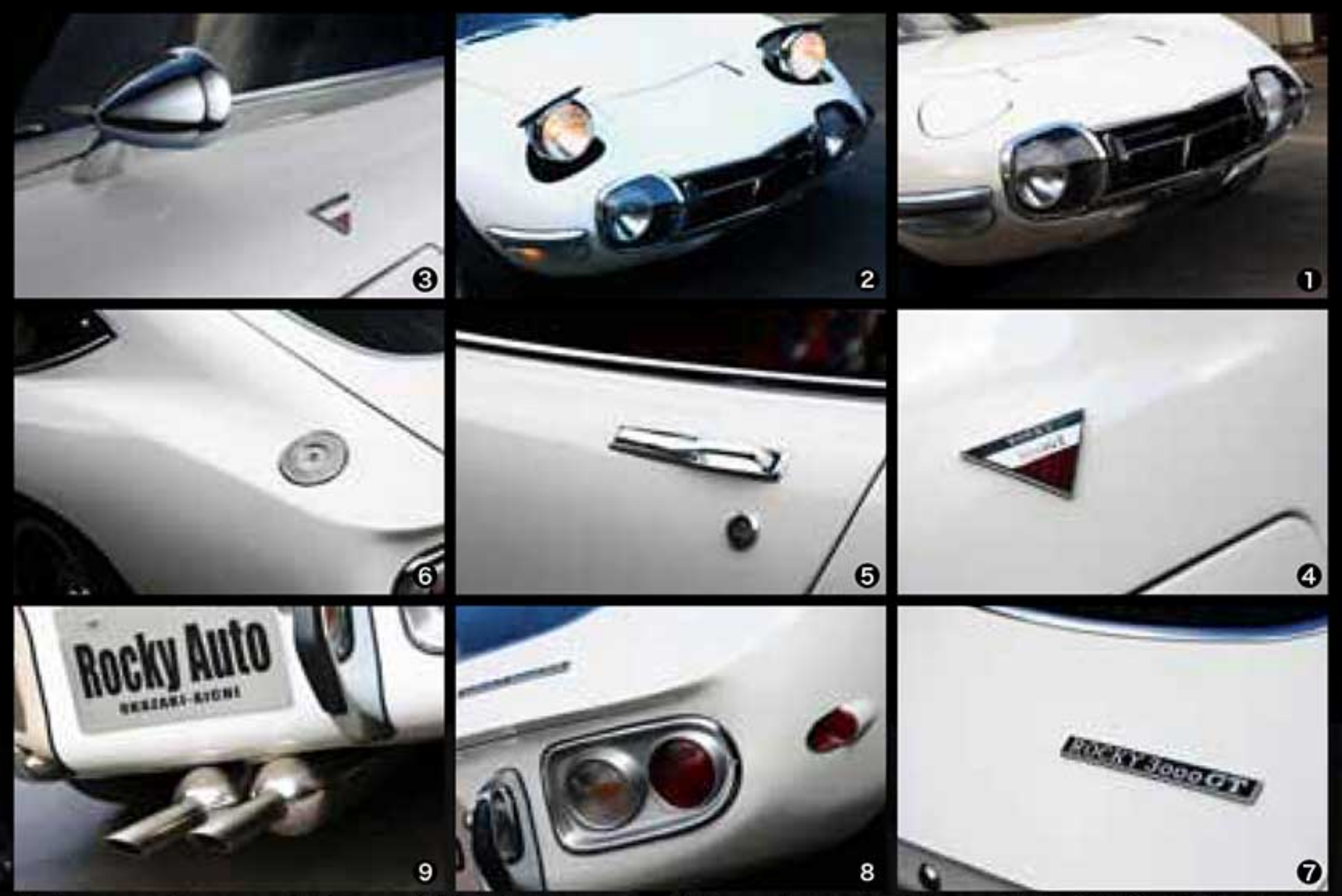
1 バンパーやグリル、レンズ類、モールなどもすべて2000GTの純正パーツを忠実に再現しているため、顔つきも見分けがつかない。各ボディパネルの合わせ目やモール類の組み付け精度も高い。2 特徴的なリトラクタブルライトももちろん可動。オリジナルの2000GTよりも動作が速く、しかも左右同じタイミングで開閉する。3 外側がメッキ、内側がツヤ消しブラックで塗られるミラーも純正同様。4 わざわざ七宝焼きで作られたエンブレムにはROCKY 3000GTの文字が入られている。色使いは2000GTと同様だ。5 ドアハンドルも2000GT独特の形状を忠実に再現。質感も十分だ。6 フューエルキャップも製地の部分とホリツグ部分が組み合わされるオリジナルをトレースする。7 リアに取り付けられるエンブレムも純正同様のデザインで、ROCKY 3000GTの文字が入られている。8 テールレンズのハウジングも製地のオリジナルを忠実に再現。9 φ63mmのステンレス製のキャブトマフラーを装着。10 まるでオリジナルと見分けがつかないリアビュー。もしかすると2000GTを見慣れている人は若干の違和感を覚えるかもしれない。が、それは実際に装着されるホイールよりも若干幅広の試作ホイールが装着されていることと、リアの高がやや低めに設定されているから。逆に言えば、そんなささいなことさえ気になるほど、全体のフォルムや他の部分の完成度が高いといえる。
