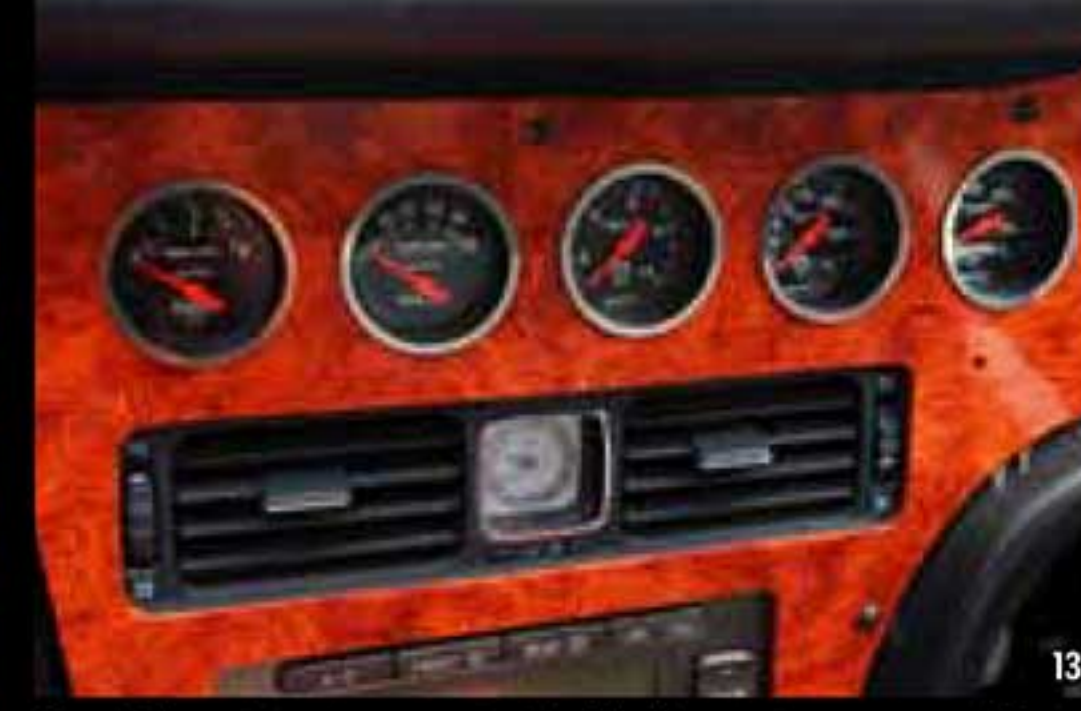
11 1号車にあたるRHVから大きく変化したインテリア。デザイン質感もオリジナルの雰囲気を保ったまま現代化されている。12 速度計と回転計は、スミス製を採用。13 小径の5連メーターは、オートメーター製。左から燃料計、電圧計、油圧、油温、水温の順。メーター下部にはオートエアコンの吹き出し口とアナログ時計を備える。ウォールナット風パネルはイミテーションだが、質感は上々。オプションで本木目仕様も選択可能だ。
