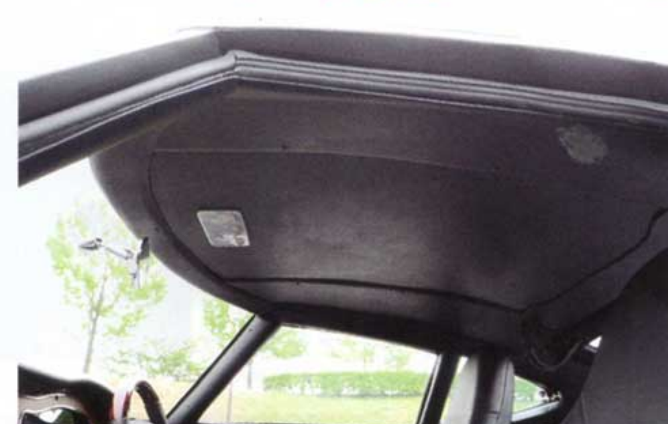
ルーフ天面の仕上げも見事。実際ルーフにはX構造の補強が入っており剛性に寄与しているが、ヘッドクリアランスは多少損なわれてしまっている
