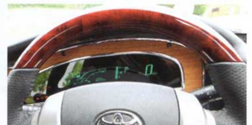
メーターもアクアの物を流用。電気メーターとなっているので情報は全て目の前
