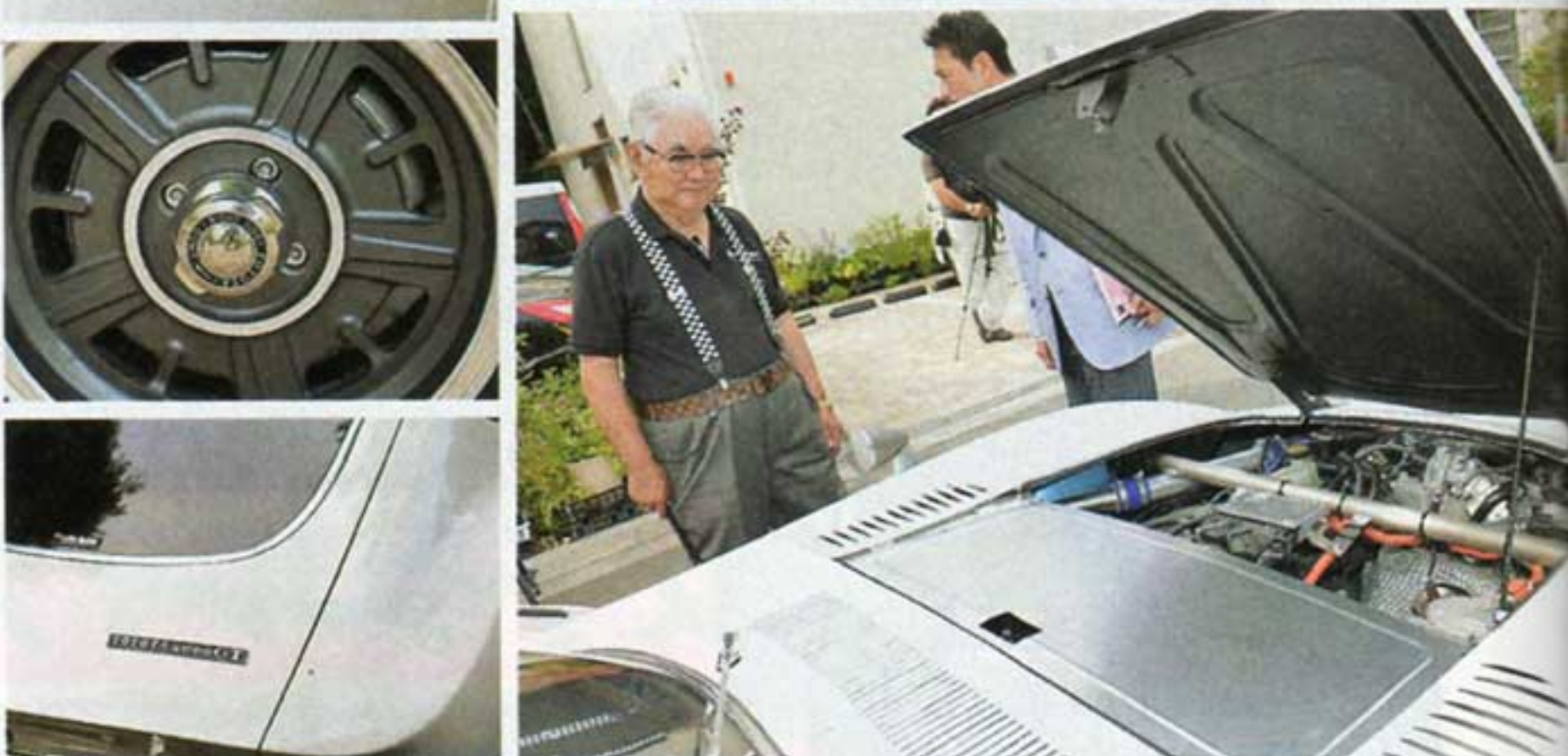
アクアのステアリングホイールを装着。「あの当時マグネシウムホイールにしたのは私の失敗だった。耐久性や部品供給のしやすさを考えればアルミにすべきだった」ということでホイールは細谷氏のアドバイスでアルミとした。エンジンルームにはアクア用の1.5ℓハイブリッドシステムが収まる
