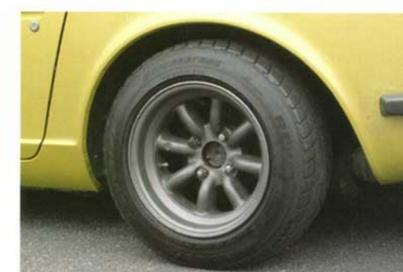
リアタイヤは195/60-14。扁平率5パーセント、わずかに10ミリのこだわりが全体のイメージを引き締める。
