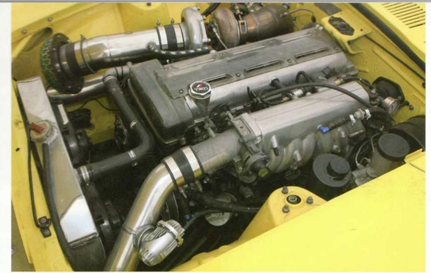
3.0リッター直列6気筒DOHC24バルブのトヨタ2Jエンジン。RBエンジンに比べ低速域のトルクが高い。
