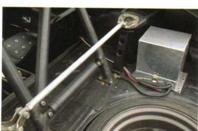
リアのダンパーヘッド間にストラットタワーバーを搭載し、リアのロール剛性を高めている。
