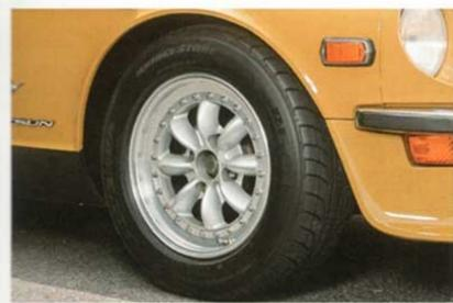
フロントタイヤは205/60-15。腰のあるストロークを感じさせるセッティングで路面を捉える。
