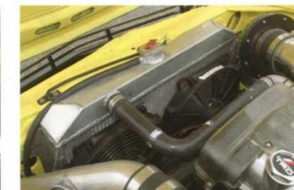
2基の電動ファンを装備した大型のラジエーターとインタークーラーが縦に整然と配置されている。
