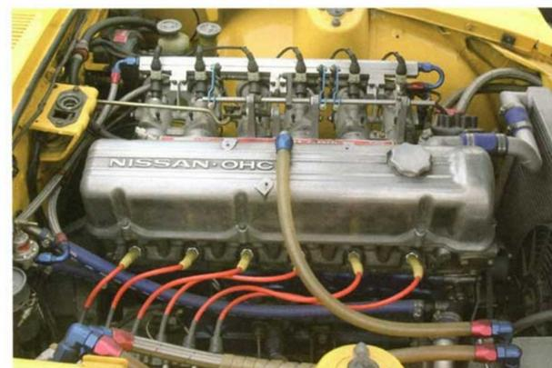
美しく磨き上げられた名器ともいえる直列6気筒のL28型エンジン。外部コイルで強烈な点火力を実現。
