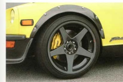
フロントタイヤは、235/R18インチと極太とし、ディスクブレーキに変更している。
