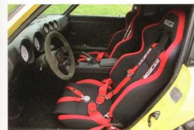
スパルコのバケットシートには、6点式のシートベルトが装着されている。
