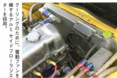
クーリングのために、電動ファンを擁するアルミサイドフロラジエーターを採用。
