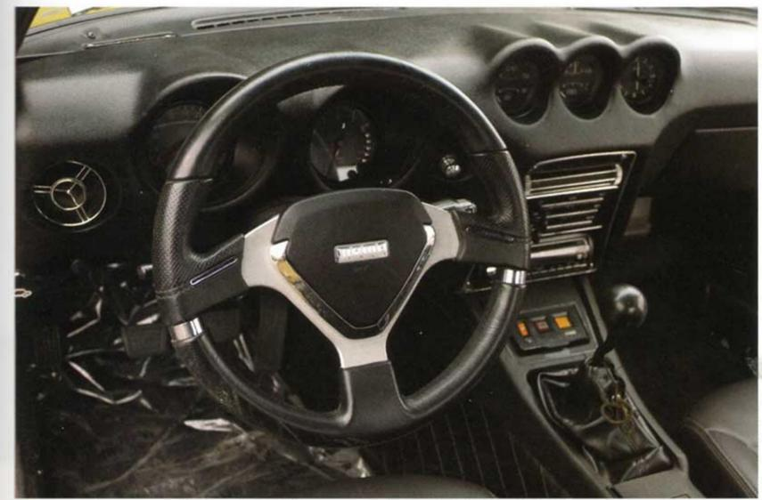
ステアリングはモモのモダンなモデルを装着。シフトノブは操作性を考慮して微妙な加工が施されている。
