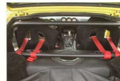
シート後方にはロールケージが設置され、シートベルトが固定されている。
