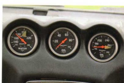
タコ・水温・油温・油圧を計測するオートメーターを搭載。シンプルで視認性に優れている。
