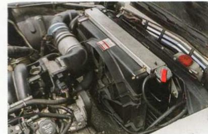
高圧縮の6リッターフルチューンを冷却するビッグなラジエーター。これでストリートも走行可能だ。
