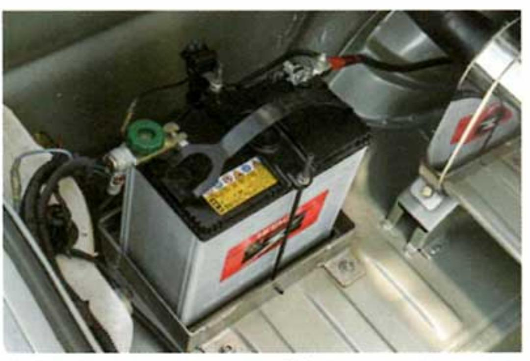
大型のバッテリーはトランク内左サイドにマウントされ、トータルでの重量バランスを追及している。
