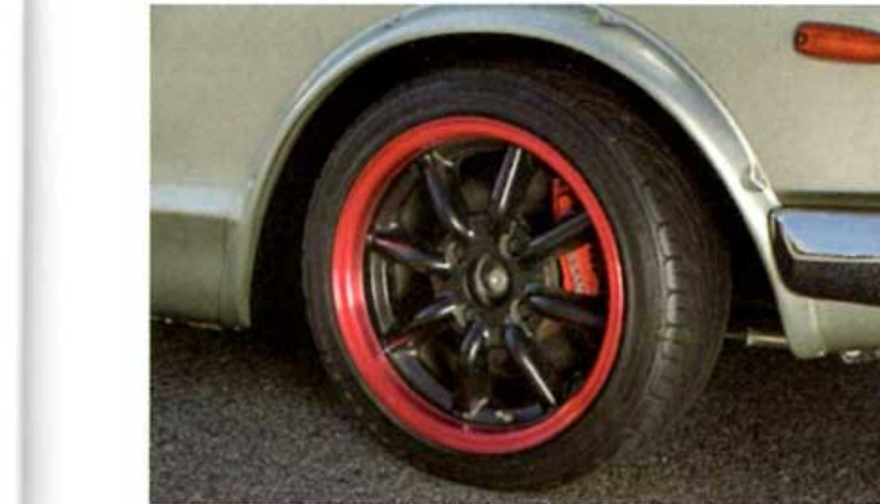
フロントタイヤは195/45R15と、偏平率が高く細めのサイズの選択で運転しやすさを追求。
