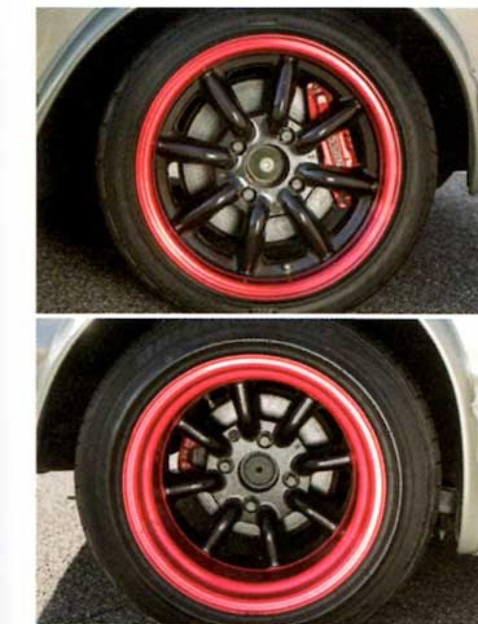
フロントはR32スカイラインタイプM用ディスクブレーキ、リアはS13シルビア用のディスクキャリパーとローターを採用。定番のチューニングだ。
