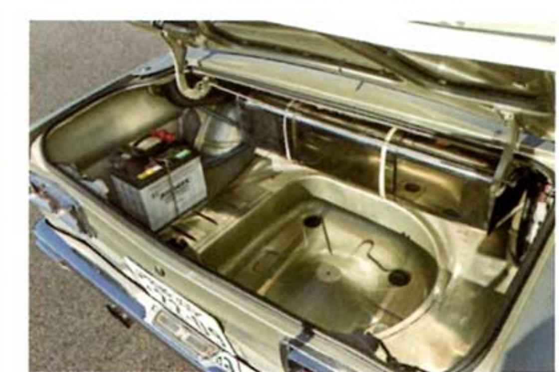
ステンレス製燃料タンクを収め、美しく仕上げられたトランク内部。細かな部分にまでこだわりが注がれる。
