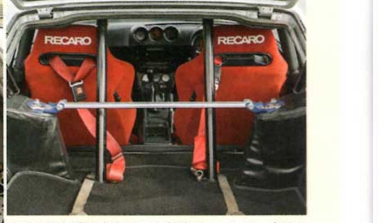
L型の黄金期に確立された定番チューンは、当然ながらインテリアにも及ぶ。車体剛性の確保もまたお約束のメニューである。
