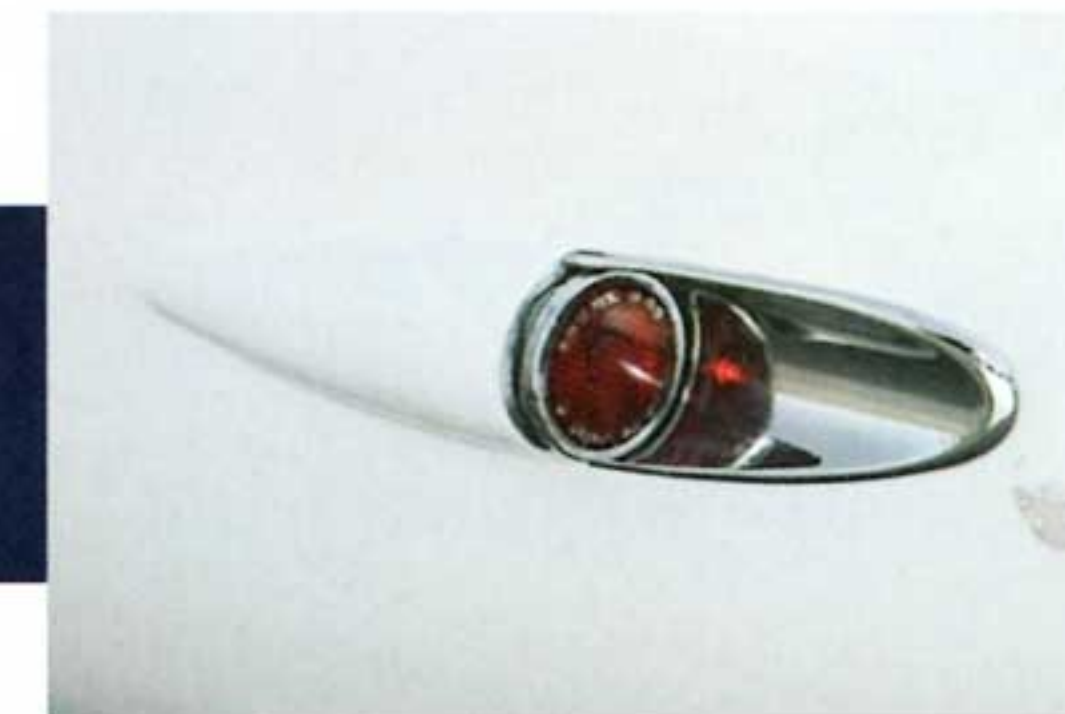
トヨニの特徴的な造形は言うまでもなく完璧に造りこまれている。ボディは基本的にフルFRP製となっている。
