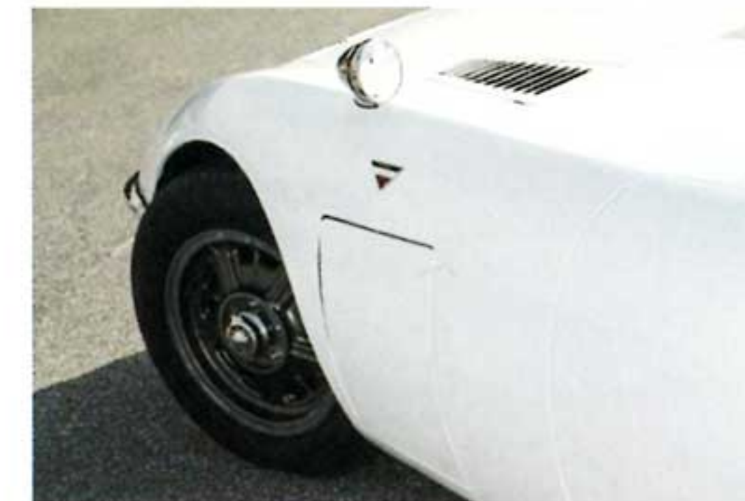
フロントフェンダー左右に設けられたバッテリーメンテを兼ねたサービスハッチも忠実に再現している。
