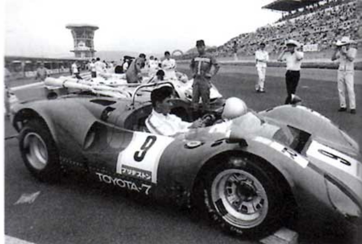
1968年の第二回富士1000kmレースのトヨタ7 (415S)。2000GTのエンジンやサスペンションが流用され開発されたマシン。
