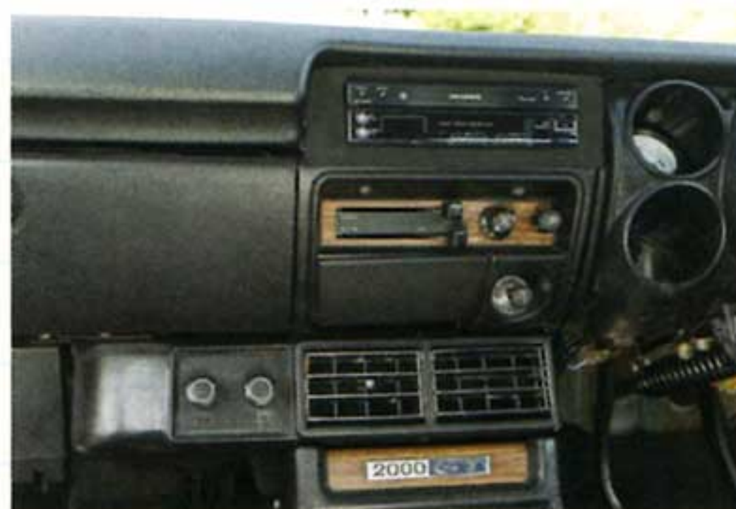
可能なかぎりノーマルのイメージを残すコンセプトの中で、見事にレイアウトされたエアコンユニット。
