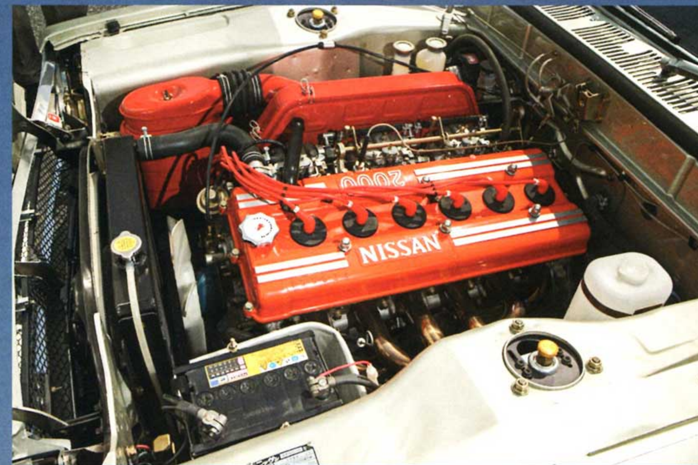
PGC10のカムカバーは黒色を採用。KPGC10では派手な赤色に変更されていた。キャブはミクニ製の3連ソレックス式。
