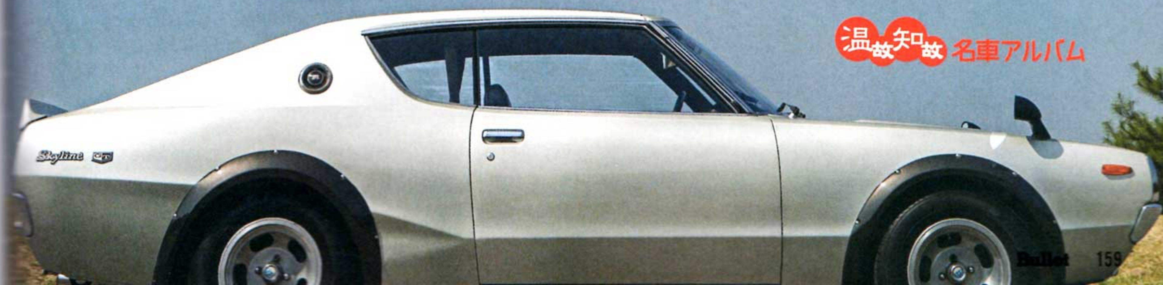
前後全てのホイールアーチに樹脂製の黒いオーバーフェンダーをボルトオン。トレッドを拡張しても、タイヤをボディからはみ出させないために当時良く用いられていた手法だ。
