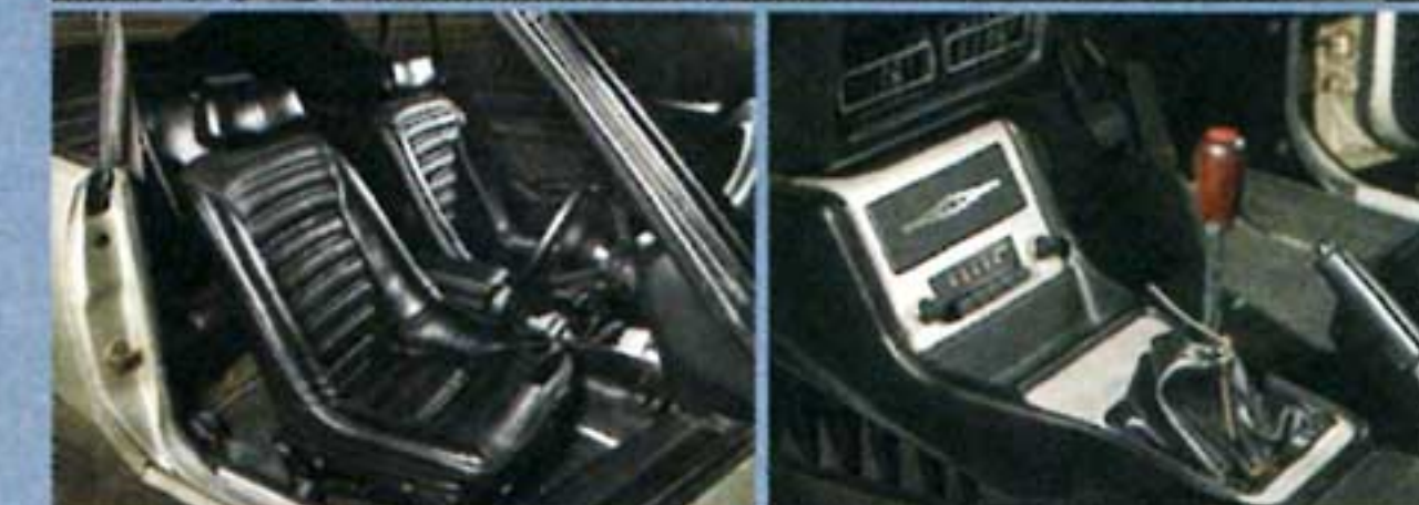
サイドサポートの利いたバケットシートに木製のシフトノブ。そして3本スポークの革巻きステアリングを装備。アルミパネルに居並ぶ丸形の7速アナログメーターも壮観だ。
