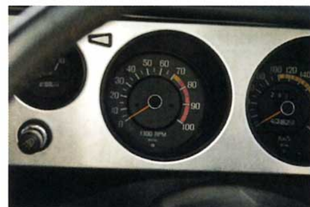
イエローは7000回転、レッドゾーンは7500回転からのレブカウンターはアルミパネルに配置された。
