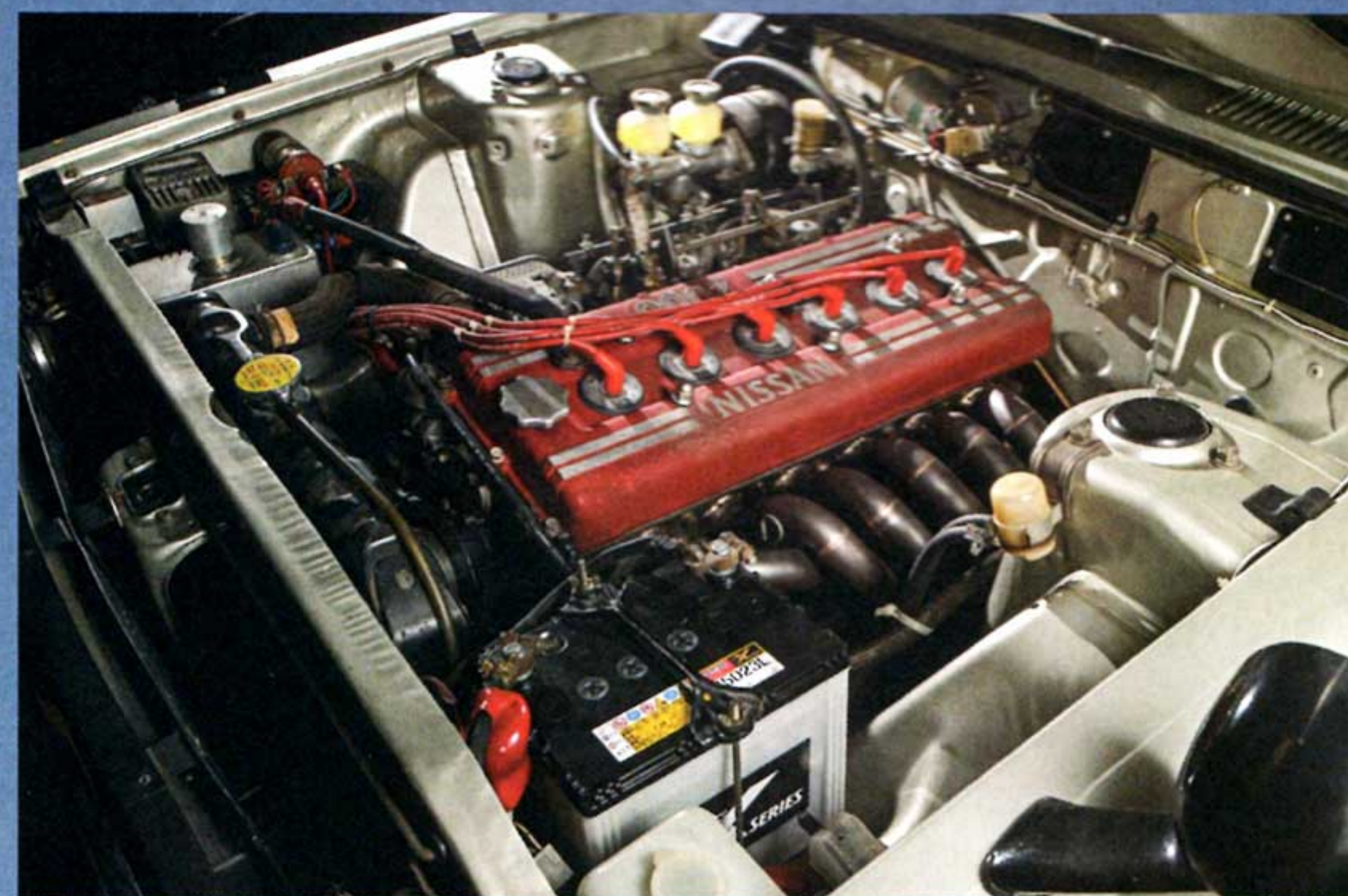
NISSANと明記された赤いカムカバー。同色のイグニッションコードは6気筒のセンタープラグへ整然と結ばれている。
