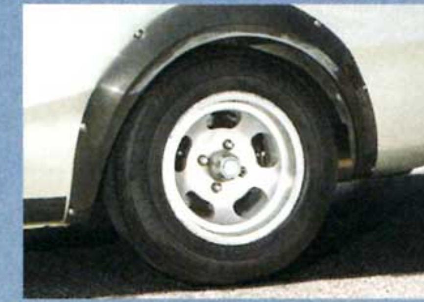
前後全てのホイールアーチに樹脂製の黒いオーバーフェンダーをボルトオン。トレッドを拡張しても、タイヤをボディからはみ出させないために当時良く用いられていた手法だ。
