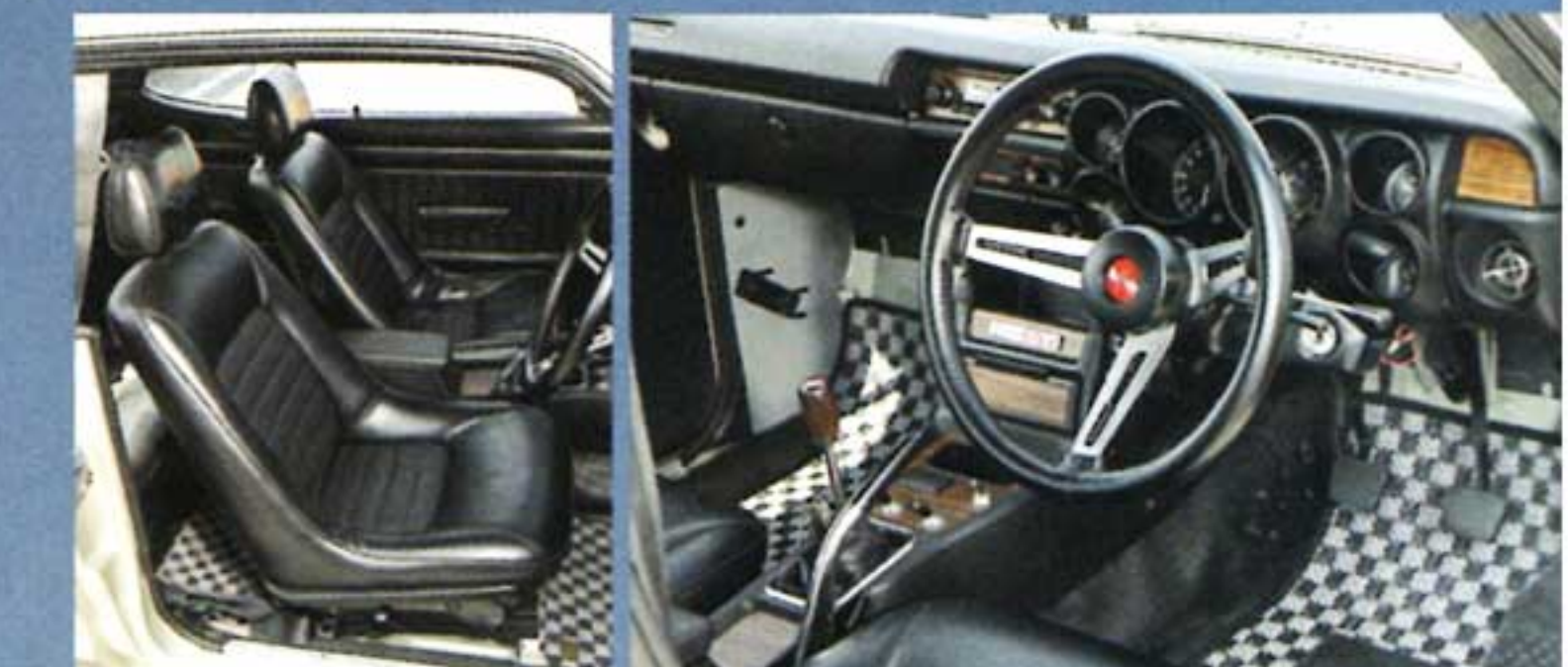
バケットシートやビッグタンクの標準装備が競技車両的。本格派スポーツカーに相応しい装備が施されていた。アクセルペダルはオルガン式。3本スポークのステアリングホイールはφ405mmの革巻きタイプ。
