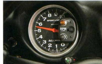
レブカウンターは、RB30改のハイパワーエンジンに合わせて換装している。シフトインジケーター付きだ。
