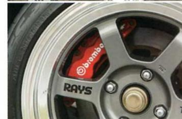
フロントは、効きを重視してブレンボキャリパー&大型ローターを装着、リアはディスク化し、ウィルウッドのキャリパーで性能と軽量化の両立を図っている。
