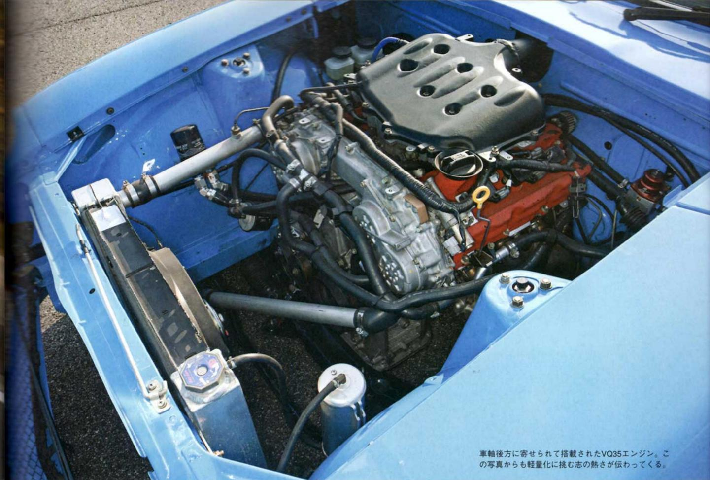
車軸後方に寄せられて搭載されたVQ35エンジン。この写真からも軽量化に挑む志の熱さが伝わってくる。
