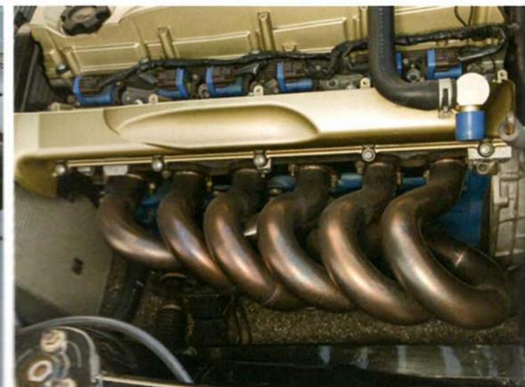
NA化されたRB26DETTのヘッドが眩しいRB30エンジン。50φのソレックスキャブ、48φの6-1エキゾーストマニホールドが美しい。このRBエンジンであるが、走りのためだけでなく、補記類にも余裕のパワーを供給してくれる。
