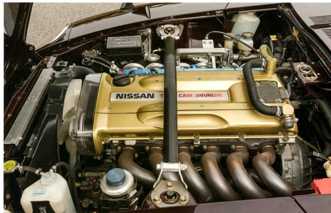
カーボン製ストラットタワーの下に鎮座するRB30改。前面に大型ラジエーターを配した上で、クーリングには徹底してこだわっている。このマウント位置が重要なのだ。
