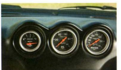
3連メーターは、水温計、油圧計、燃料計に換装している。シンプルなデザイン。
