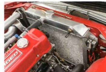
きわめて大型のアルミラジエター。スーパーチャージャーを効かせまくっても安心のクーリング性能。
