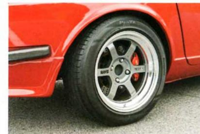
リアタイヤは、205/55ZR16。駆動輪であることから、高速レンジのZRタイヤを装着。
