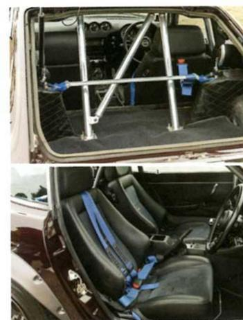
アルミロールバー6点式と、乗員の上体をしっかりとサポートしながらもこの車両にマッチしたデザインのリカロシート。ドライバー側は4点式シートベルトが装着される。
