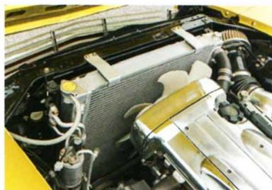
大型のアルミラジエターを搭載。ハイパワー化にともないクーリング性能を向上させなければならない。
