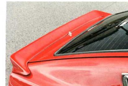
ボディ同色のリアスポイラーはシンプルなデザイン。高速時にリアの浮き上がりを抑制する。
