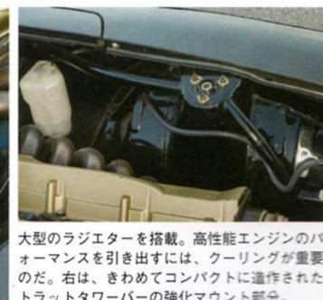
大型のラジエターを搭載。高性能エンジンのパフォーマンスを引き出すには、クーリングが重要なのだ。右は、きわめてコンパクトに造作されたストラットタワーバーの強化マウント部分。
