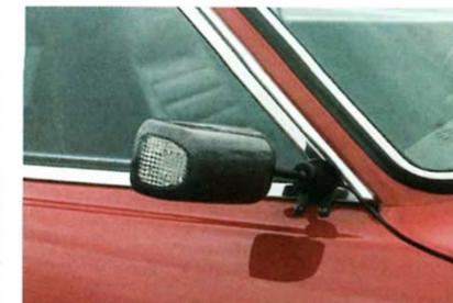
カーボン製ドアミラー。シンプルでユニークな造形だ。ウインカーライトも内蔵されている。
