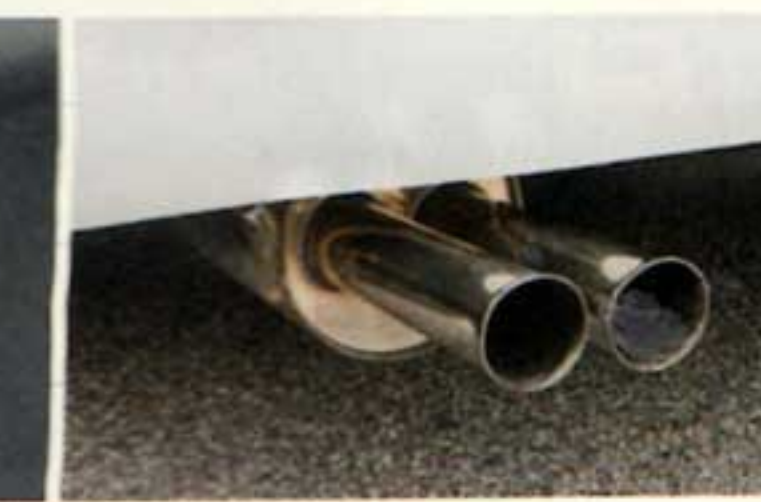
快適ドライブに必要な要素は全て盛り込んである。オリジナルのステンレスマフラーからは、GTカーらしい音質のエキゾーストサウンドが響くが、その音量は決して大きくはない。
