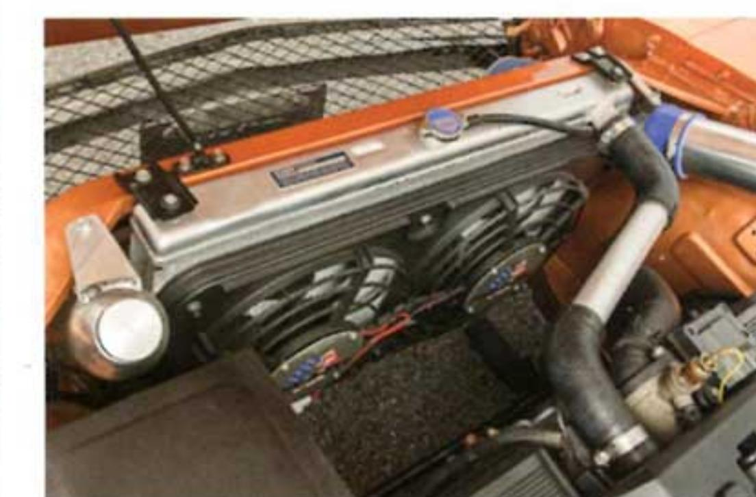
大形のラジエーターに電動ファンを2連装。V8が発生する小さくはない熱量を効率的に交換している。
