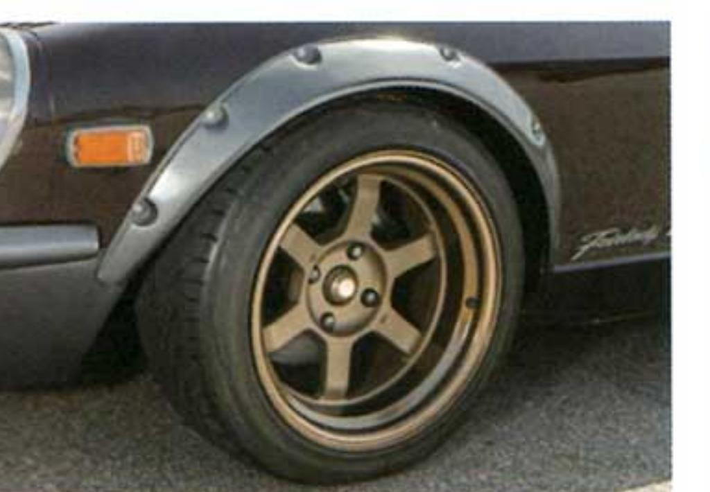
フロントタイヤは225/45ZR-16を履く。機敏なコーナリングに大きく貢献している。
