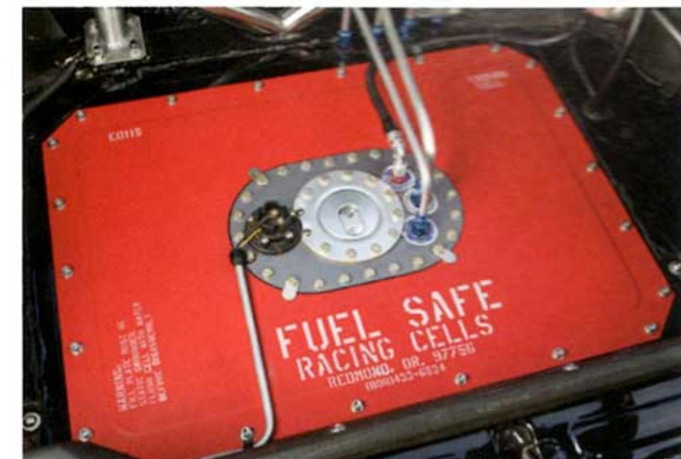
長距離ドライブも可能にする大容量燃料タンクは、レースでおなじみのセーフティタンクを搭載する。
