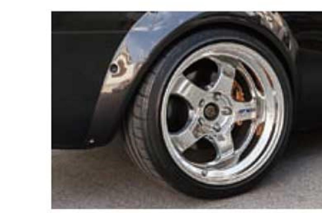
リアタイヤは幅255で扁平率は35%の18インチ。このビッグなタイヤをいとも簡単にスピinnさせるパワーだ。
