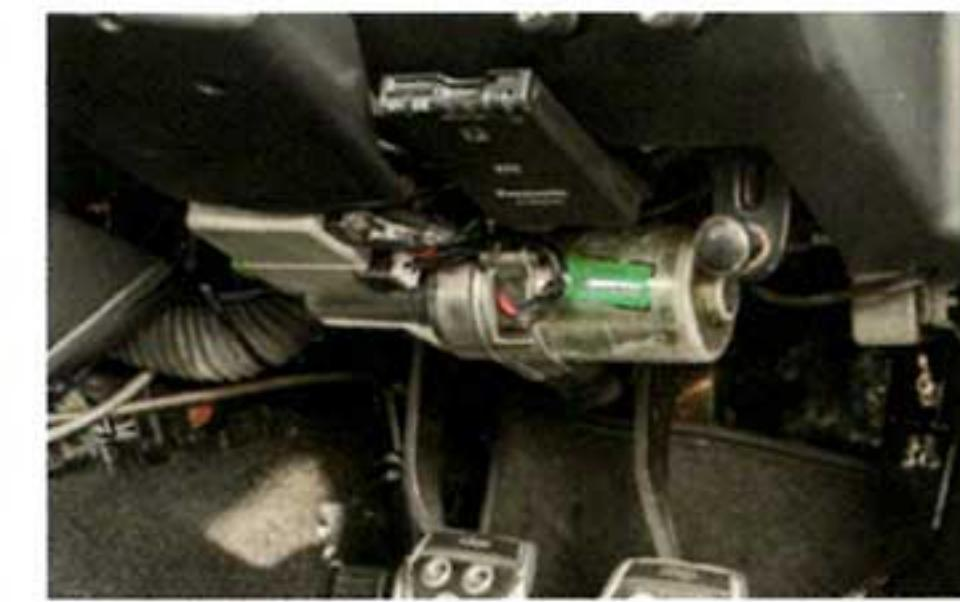
電動アシスト式のパワーステアリングも装着。低速時の取り回しが格段に楽になっている。
