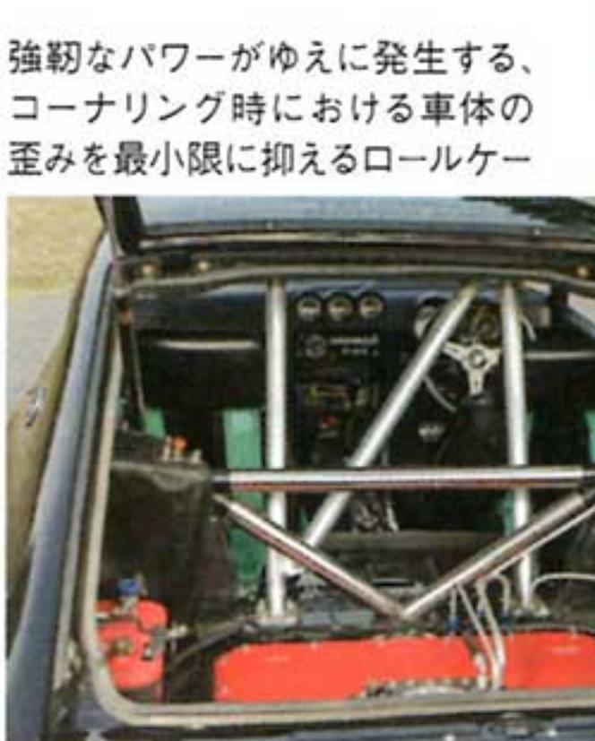
強靭なパワーがゆえに発生する、コーナリング時における車体の歪みを最小限に抑えるロールケー
