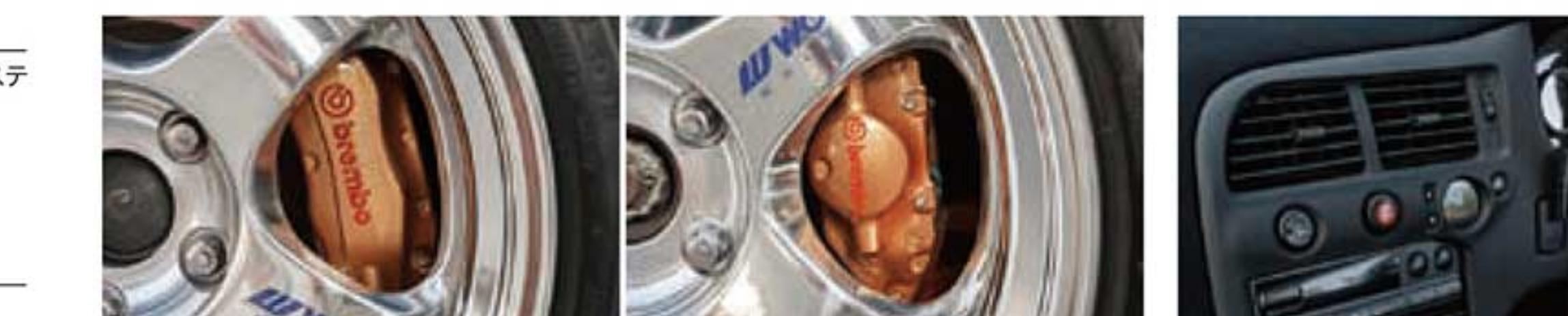
フロントのブレーキキャリパーはR34譲りのブレンボ製4ポッド。リアにも同じくR34のディスクユニットが装着され、確かなストッピングパワーを発揮する。
