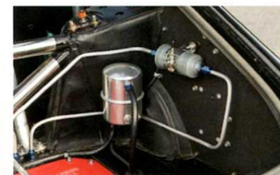
加給によって要求される燃料を確実に送るポンプシステムはリアハッチ内に装着される。
