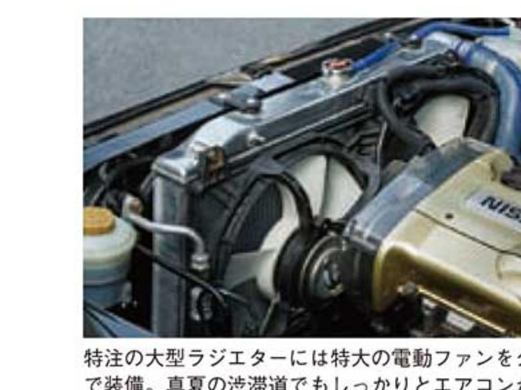
特注の大型ラジエーターには特大の電動ファンをダブルで装備。真夏の渋滞道でもしっかりとエアコンが効く。
