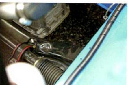
エンジン搭載するにあたって数多くの難題をクリアしなければならないが、サスペンションメンバーがあるため、全高の高いVQはその後ろにしか搭載できない。が、それにより重量配分等も良くなった。下の写真はステアリングシャフト。ピロマウント等を使い、角度を付けて作動させているのが分かる
