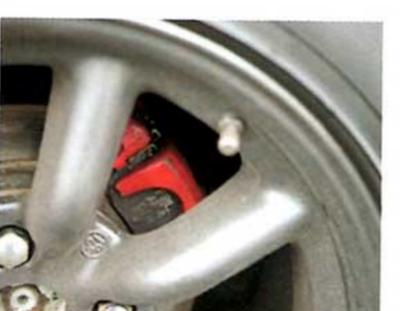
↑前後ブレーキも抜かりなく強化。フロントブレーキはロッキーオートのロゴが入る4ピストン削りだしキャリパーに、2ピースローター。リアブレーキもディスク化されていてシルビア系のキャリパーを装着している。もちろんサイドブレーキも装備。フロントアーム類もパイプタイプに全て交換され、フルピロ化を行いステアリングロッドなども交換、ロールセンターも適正值に修正
