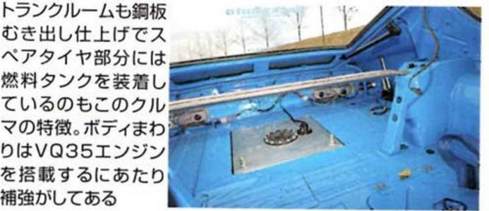
トランクルームも銅板むき出し仕上げでスペアタイヤ部分には燃料タンクを装着しているのもこのクルマの特徴。ボディまわりはVQ35エンジンを搭載するにあたり補強がしてある
