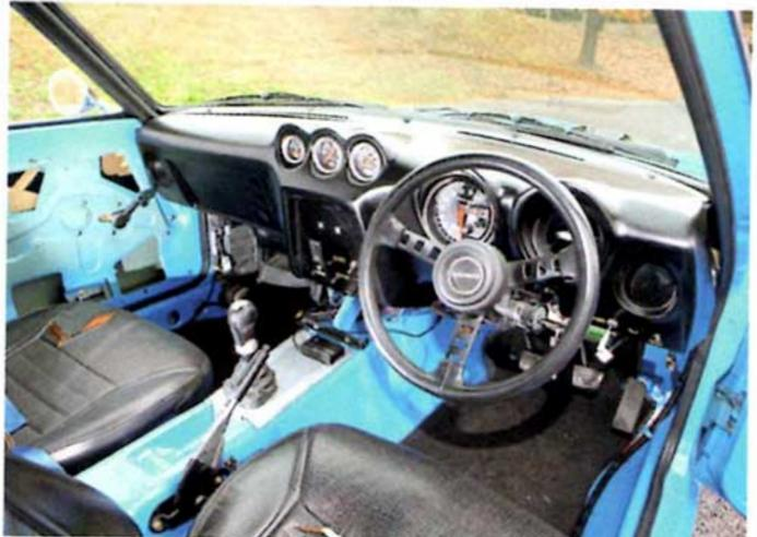
室内はかなりレーシングな仕上がりで内装類も付いて無くエアコンなどの快適装備もZ33エンジンや配線を使用しているため比較的簡単に移植できるが、敢えて付けず軽量化
