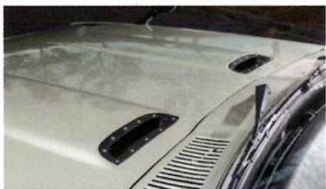
NAのGTSベースに比べ発熱量が多いRB26DETT型搭載のGT-Rベース車ではボンネット後端にエアアウトトレットが設けられている。
