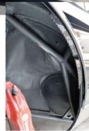
●フロントフェンダーを内側から見ればロッキーオートらしくパイプフレームを追加してボディ剛性を大幅に強化していることがわかる。800psを支えるならこれも必須だ。
