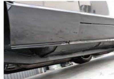
●2本のメインフレームはより強度の高い鋼材を使用して純正に被せるように追加している。パネルの再接ととも、大幅なパワーアップをしてもビクともしないボディに仕上がる。
