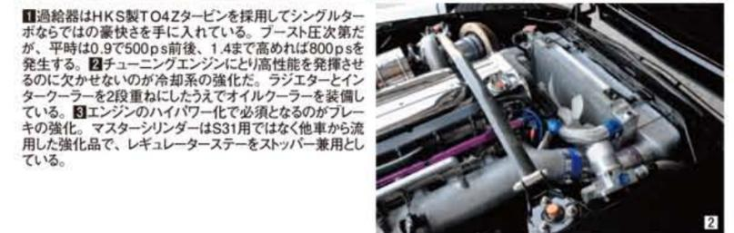
■過給器はHKS製T04Zタービンを採用してシングルターボならではの豪快さを手に入れている。ブースト圧次第だが、平時は0.9で500ps前後、1.4まで高めれば800psを発生する。②チューニングエンジンにこり高性能を発揮させるのに欠かせないのが冷却系の強化だ。ラジエーターとインタークーラーを2段階重ねにしたうえでオイルクーラーを装備している。③エンジンのハイパワー化で必須となるのがブレーキの強化。マスターシリンダーはS31用ではなく他車から流用した強化品で、レギュレーターステーをスッパージョイントとして流用している。
