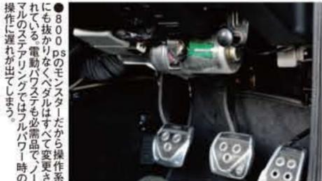
●800psのモンスターだから操作系にも抜かりなくペダルはすべて変更されている。電動パワステも必需品で、ノーマルのステアリングではフルパワー時の操作に遅れが出てしまう。
