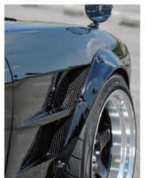
●フロントフェンダーはブレーキの放熱性を向上させるため、大きなエアダクトが設けられて追力満点。アラゴスタ製サスペンションを支えるのはF215/45R17、R245/45R17だ。
