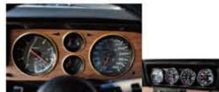
●雰囲気を壊さないようメーター単体での交換とされている。スピードは300km/hスケールとなり、タコは10000rpm対応のAPEX製だ。
