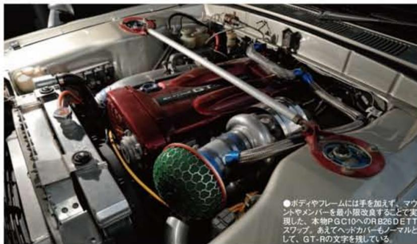
●ボディやフレームには手を加えず、マウントやメンバーを最小限改良することで実現した。本物PGC10へのRB26DETTスワップ。あえてヘッドカバーもノーマルとして、GT-Rの文字を残している。
