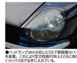
●ヘッドランプはHID化したうえで樹脂製カバーを装着。これにより空気性能の向上とともに妖しいルックスまでも手に入れている。
