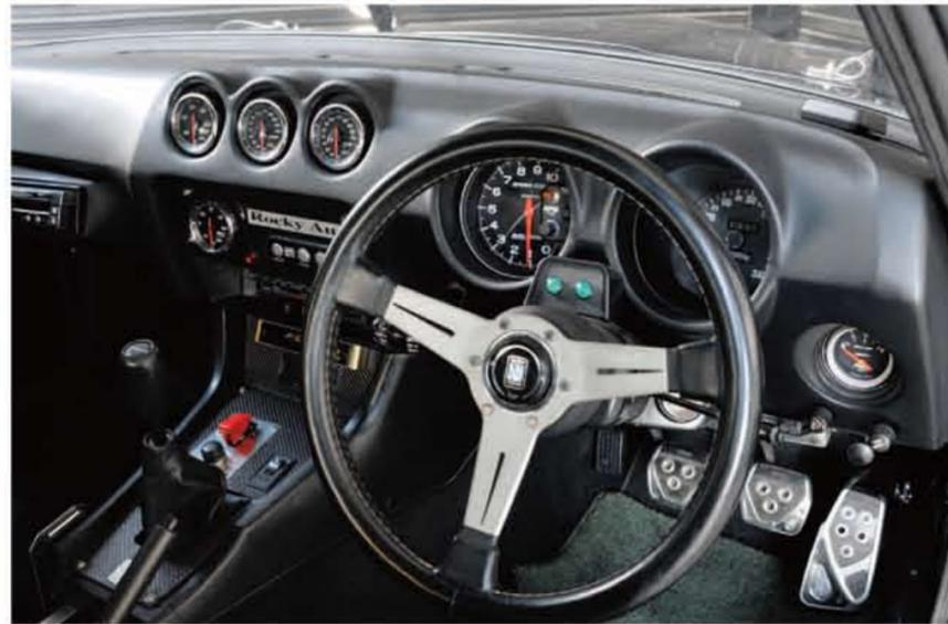
●室内は純正の雰囲気を崩さずアップデートしている。エアコンを深く採用しなかったため、空調の吹き出し口までメーターを埋設して計器類も万全の備えとなっている。
