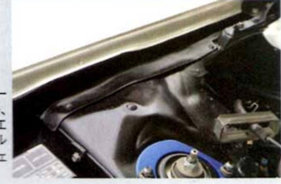
●インナーフェンダーも切り抜いていたため、新たに製作したものをエンジンルームのパネルに固定してアワーフェンダーを支える。
