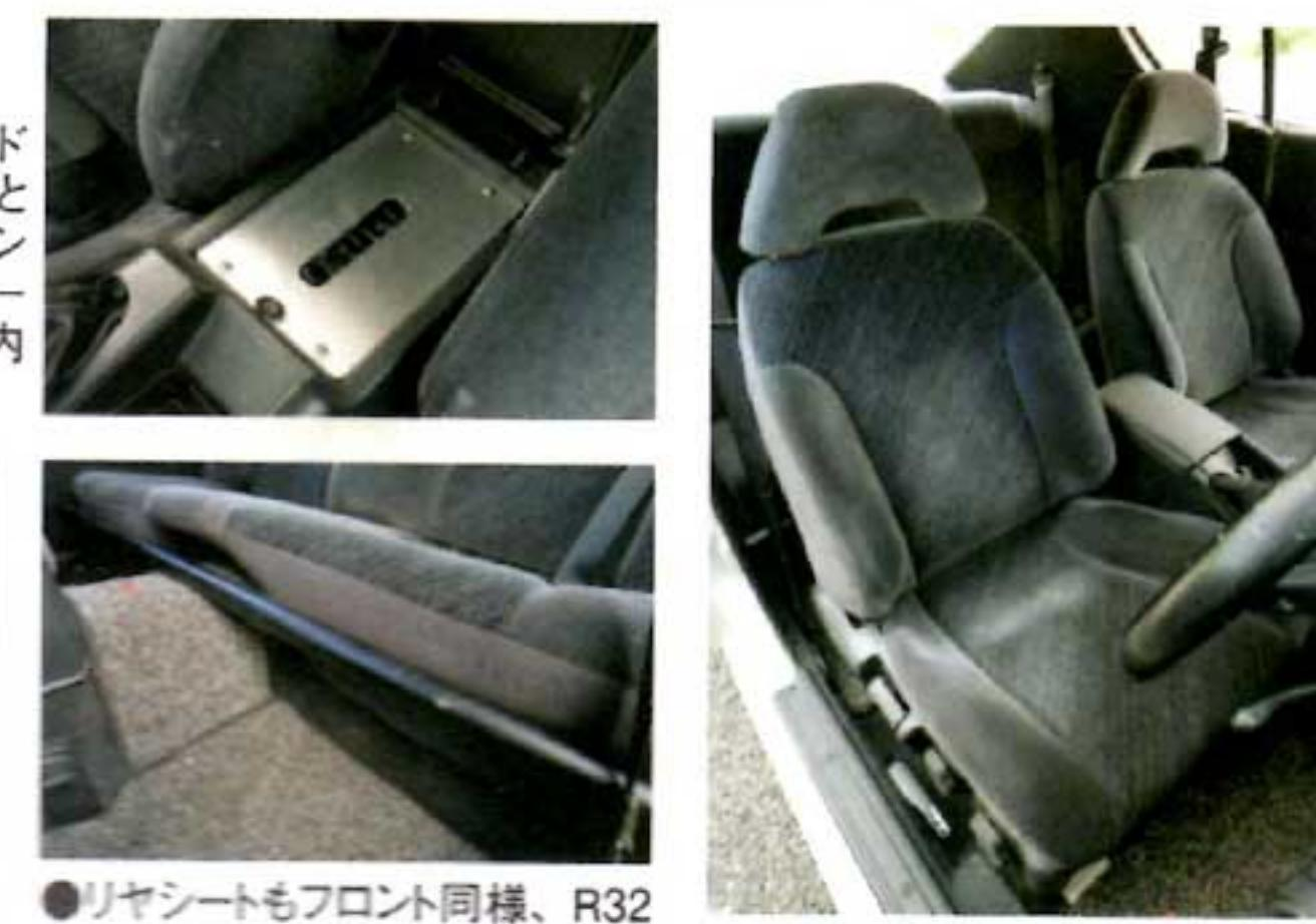
●ドア内張はドアハンドルとアームレストのみとなるため、パワーウィンドースイッチはセンター コンソールのボックス内に収納されている。
