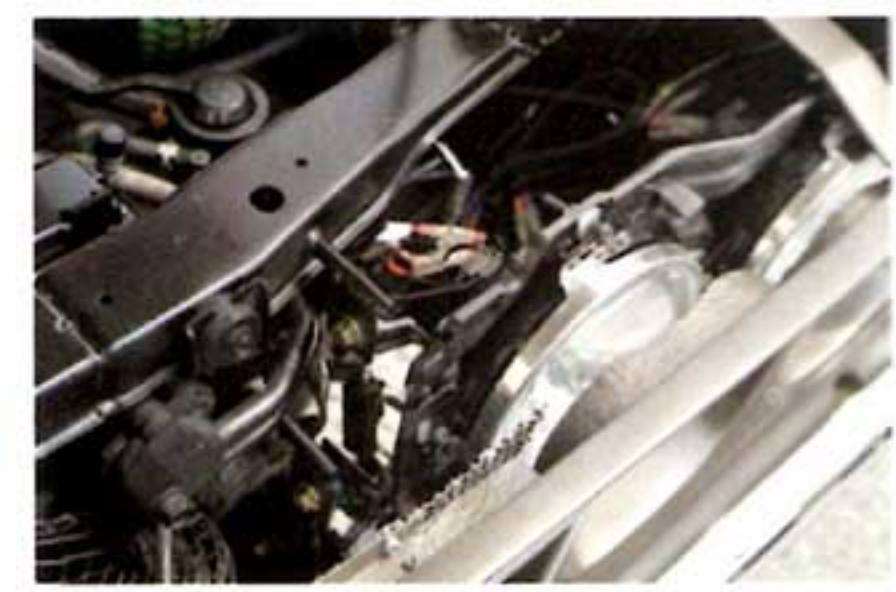
●ヘッドランプは一般的なハロゲンだが、ランプステーは寸法から割り出した他車用バーツをうまく流用している。この辺のノウハウはサスガだ。
