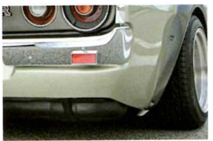
●R32は燃料タンクを床下に吊り下げるため、ケンメリのリヤフェンダーだとほどもバネルを下に延長させた。オーバーフェンダーともどもバネルを下に延長させた。
