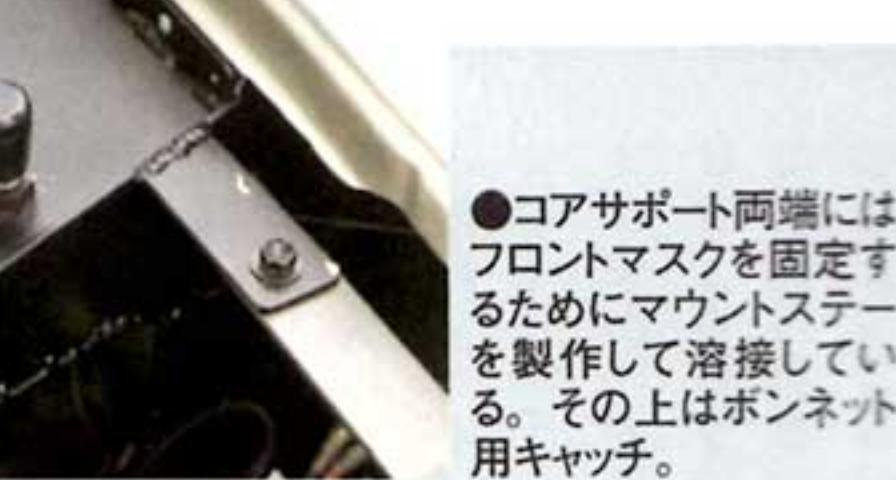
●コアサポート両端にはフロントマスクを固定するためにマウントステーを製作して溶接している。その上はボンネット用キャッチ。
