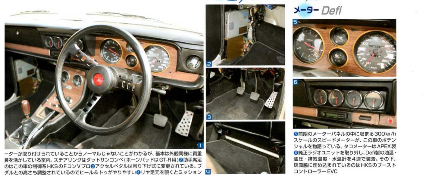
ターゲ取り付けられていることからノーマルじゃないことがわかるが、基本は外観同様に貴重表を活かしている室内。ステアリングはダットサンコンベ(ホーンパッドはGT-R用)助手席足のはこの車の制御系HKSのFコンVフロアクセルペダルは吊り下げ式に変更されている。フダルの高さも調整されているのでヒール&トゥがやりやすい。リア足元を覗くとミッションとつながる補強バーが入っている
