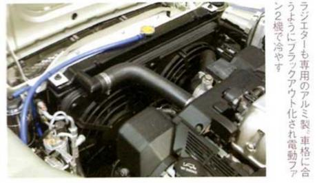
エンジンも専用のアルミ製。車格に合わせてようにブラックアウト化され電動ファン2機で冷却す
