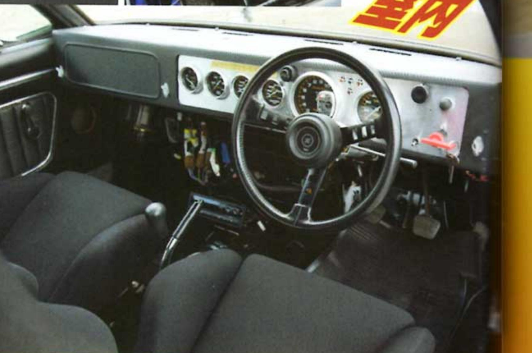
↑ダッシュボードも見事にワンオフ製作され、カーボン調（下地はアルミ曲げ材）の雰囲気を出していて、この箱スカ特有の個性を引き出している
