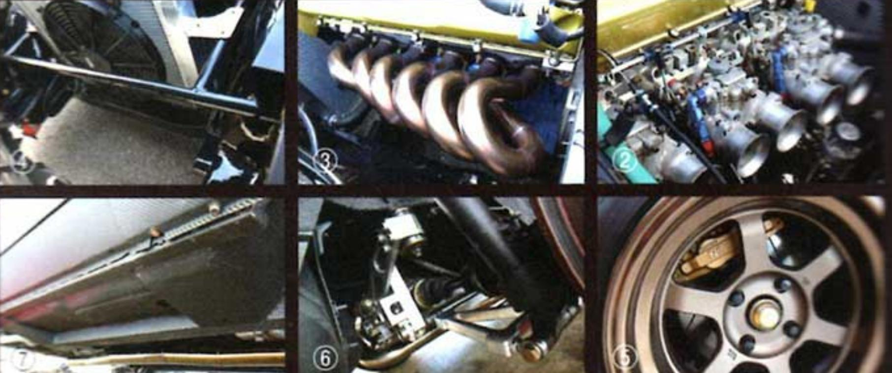
ツインカムであることを主張するゴールドのカムカバー。エキマニは6-1タイプのステンレス製だ。ダッシュ貫通したロールケージは、エンジンルームのサブフレームと連絡して車体剛性の向上に貢献。シャシー下部のフレームも強化済みだ。サスペンションのアーム類やデフマウントはビレット製の物に交換。ブレーキはR32スカイラインを移植してある。
