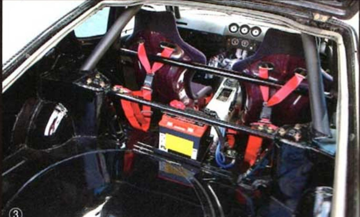
ライトウェイトな走りを存分に楽しめるように、シートはブリッド製フルパケットをセット。ロールケージはダッシュ貫通タイプで、リア側の補強も充分。インパネはレーシーなアレンジだ。
