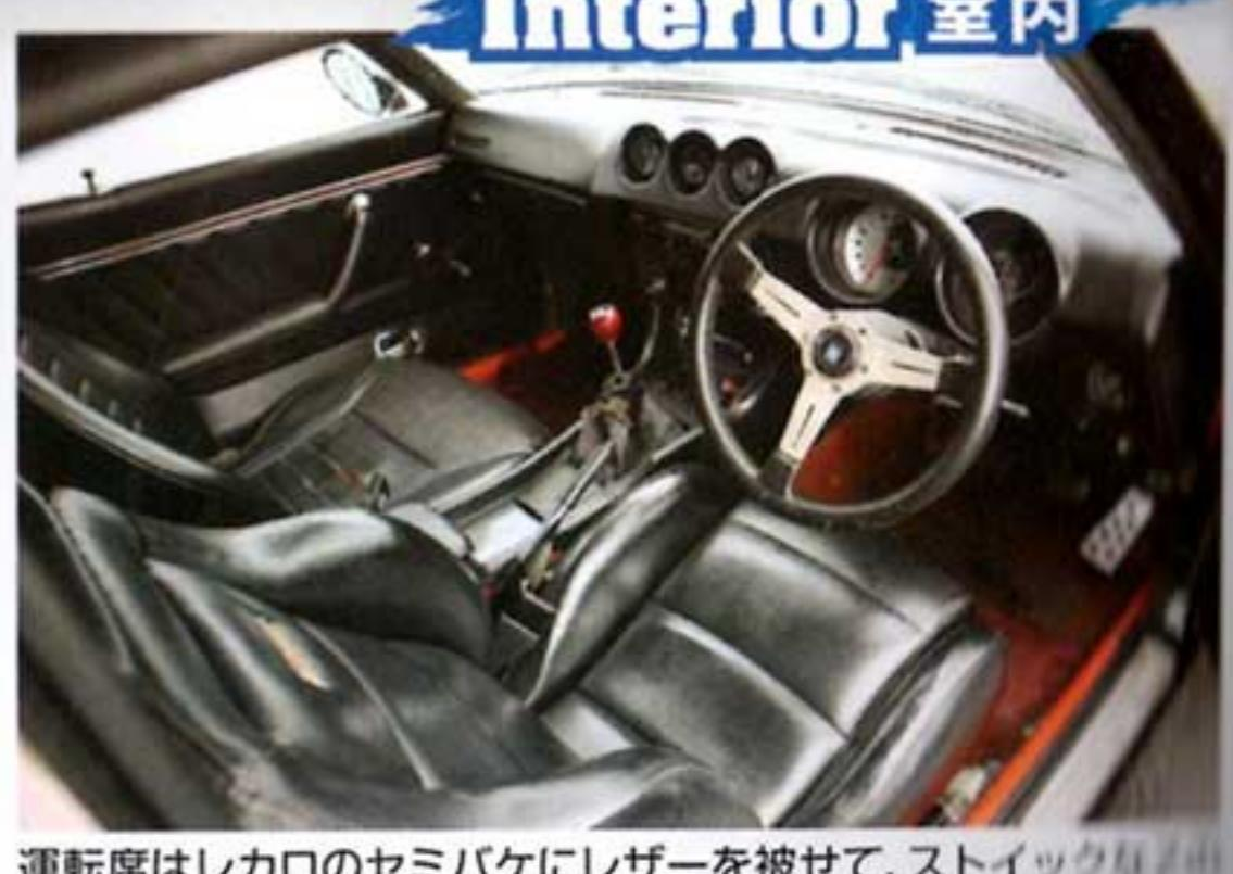
運転席はレカロのセミバケにレザーを被せて、ストイックな車内と雰囲気を合わせる。ステアリングはナルディクラシック。タコはオートメーター、3連メーターはSTACK製に交換
