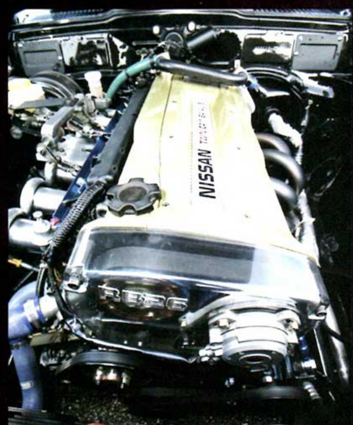
ボンネットを開け放せば、そこには見慣れたRB26DETTのヘッドが。ただし、本体はRB30でありつつ、あえてNAにこだわった。
