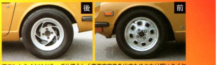
フロントタイヤはドラッグ仕様らしく直進安定性を出すためかなり細いタイヤ(165/80-15)を履くが、リヤタイヤはミッキートンブノンET STREETを装着する
