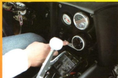
バックギヤはまずこのボタンを入れてから。操作方法を聞かないと動かすのも躊躇してしまう
