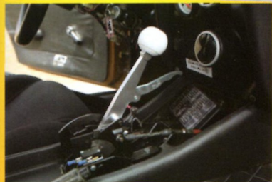
ミッションはアメリカで製作されただけあって、AT仕様。この仕様だと実際ATの方がドラッグの場合、速いことが多い
