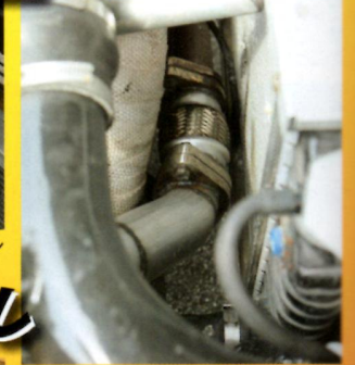
エンジンとラジエターの間に排気管やインタークーラー系が集中する。効率やスペース的な事を考えてのことだろう
