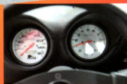
スピードメーターとタコメーターは、 白地のファントム製に交換されている
