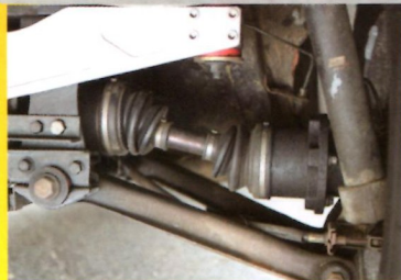
ドライブシャフトも等長タイプが入れられ、スタート時の強力なトラクションとトルクに耐えられる構造
