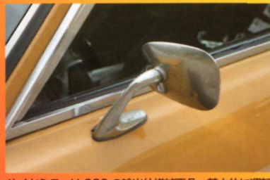
サイドミラーはS30の輸出仕様純正品。基本的に運転席側(左側)にしか装着されない
